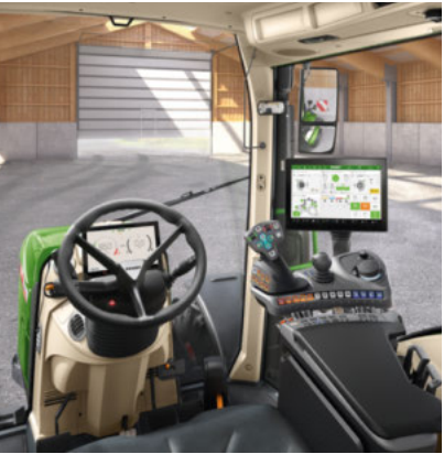
Profi+ Setting 1 - Ristivipu - Hydrauliventtiileitä käytetään yhdellä lineaarivivulla (keinukytkinparilla) - 12 tuuman pääte
