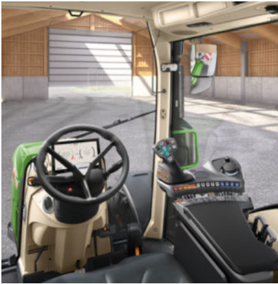
Power Setting 1 - Ei ristivipua - Hydrauliventtiileitä käytetään yhdellä lineaarivivulla (keinukytkinparilla)
