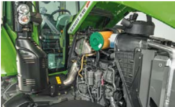
Tehokas ja helposti vaihdettava ilmansuodatin varmistaa puhtaan imuilman.
