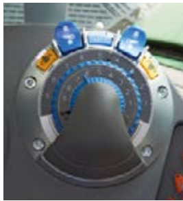
Looginen käyttö kompaktin nostolaitteen ohjausmoduulin (EPC) ja voimanoton hallintakytkimen avulla.
