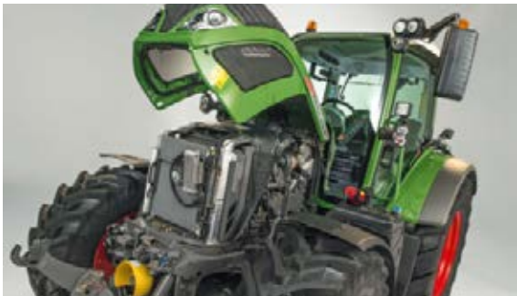
Moottoritila on erittäin hyvin ulottuvilla tarkastusta ja huoltoa varten, myös etukuormaajalla varustettuna. Kaksiosainen konepeitto on helppo avata.
