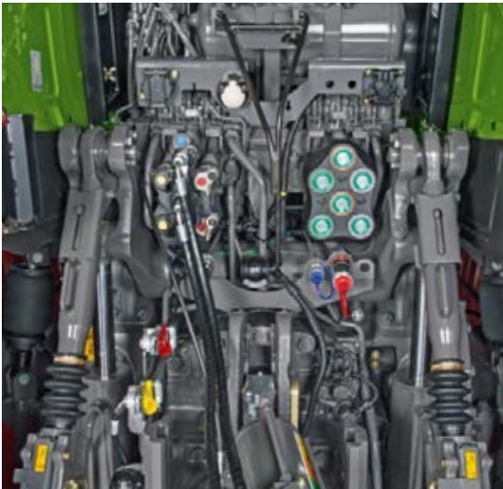
Fendt 1000 Vario -traktorin voi räätälöidä uusilla tai aikaisemmillä varusteilla. Takaosaan on sijoitettu kaikki tarvittavat liitännät ja toiminnot, kuten Power Beyond, ISOBUS-pistorasia, paluuvirtaus, voimanotto ja takanostolaite.
