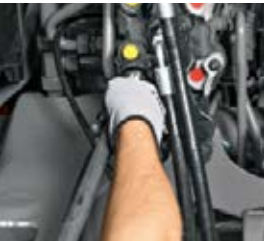
Automaattisesti sulkeutuvat venttiilien kannet suojaavat järjestelmää likaantumislta ja mahdollistavat liittimien kytkennän yhdellä kädellä.
