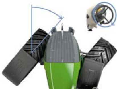
VarioActive-ohjausjärjestelmän ansiosta pyörät saa täyteen kääntökulmaan yhdellä ohjauspyörän kierroksella.
