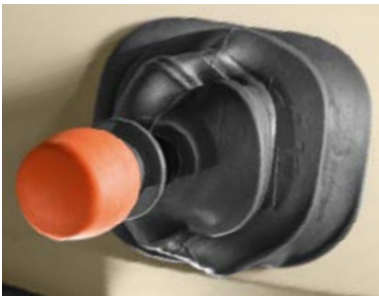
Käsijarruavustin automaattiasennossa: käsijarru kytkeytyy automaattisesti.
