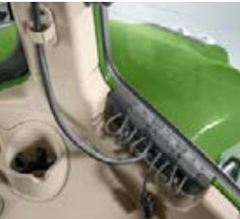
Kaapeliläpivienti mahdollistaa kaapeleiden viennin siististi takaikkuna suljettuna, jolloin ohjaamo on suojattu lialta, vedeltä ja melulta. Ei johtosotkua: kaikki kaapelit on kiinnitetty siististi C-pylväässä olevaan kaapeliohjaimen.
