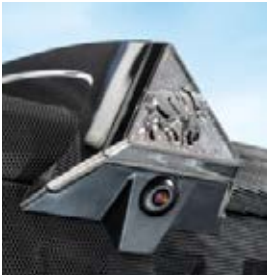
Käytännöllinen eteen kiinnitettävien työkonoiden käytön yhteydessä: Konepeittoon asennettu kamera näkee myös alavarret ja näyttää kuvan Vario-päänteen näytössä.
