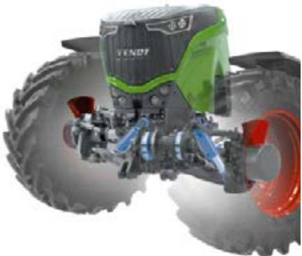
Etuakseli tasonsäädöllä varustetulla pyörien erillisjousituksella ja erillisjarruilla
