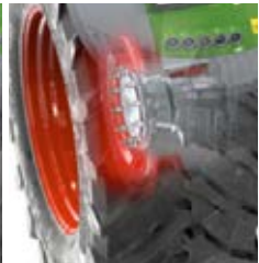
Fendt 1000 Variossa on laippa-akseli tai tappiakseli erilaisten vaatimusten täyttämiseksi.
