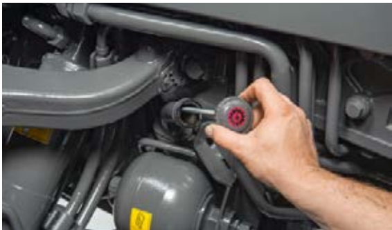
Fendt 1000 Varion huoltotyöt, kuten öljytason tarkastus tai suodattimen vaihto onnistuvat nopeasti ja helposti. Moottoritila on erittäin hyvin käsien ulottuvilla irrotettavien sivupaneelien ansiosta.
