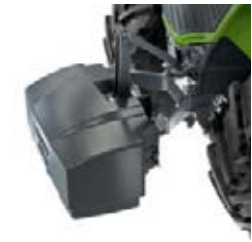
Lisäpainon nostotoiminnolla etupainot voidaan poimia nopeasti ja helposti myös ilman etunostolaitetta.
