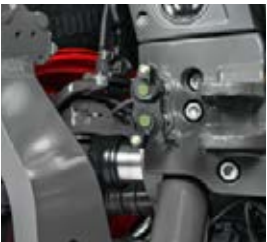
Fendt 1000 Variossa on liitännät jopa seitsemälle hydrauliventtiilille, kuusi takana ja yksi edessä.
