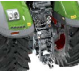
Yksinkertaisempi takaosan varustelu, esim. ilman takanostolaitetta ja voimanottoa, sisältää edelleen täydellisen valikoiman modulaarisia kytkentäjärjestelmiä, joita voidaan vaihtaa tarpeen mukaan.
