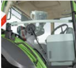
Sivuiikkunan pyyhkijä, jonka pyyhintäalue on 220°, varmistaa lisäksi optimaalisen näkyvyyden oikealle puolelle myös hankalissa olosuhteissa.
