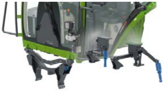
Ohjaamo on tuettu mekaanisesti neljästä pisteestä: edessä kahdella kartiolaakerilla ja takana kahdella ilmajousielementillä.
