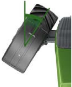
VarioActive-järjestelmän kanssa 1 kierros = 40,3°
