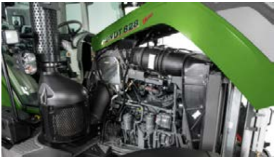
Ylös kääntyvä konepelti ja helposti irrotettavat sivupaneelit tarjoavat erinomaisen pääsyn moottoritilaan.
