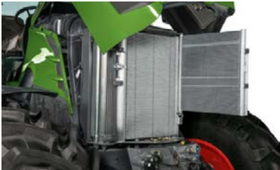
ja jäähdyttimeen on helppo päästä käsiksi sen kaivatessa puhdistusta.
