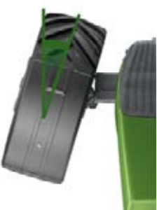
Ilman VarioActive-järjestelmää 1 kierros = 23,6°
