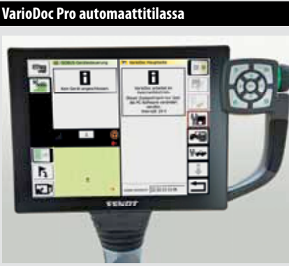
VarioDoc Pro antaa tarkat sijaintitiedot peltorekistereihin. Koneen tiedot, kuten moottorin kierros-luku, polttoaineen kulutus tai voimanoton kierrosnopeus, voidaan rekisteröidä kaikista sijainneista. Riippuen käytössäsi olevasta versiosta voit esimerkiksi tarkastella tehtyjä töitä graafisesti tietokoneella karttojen avulla, joissa on esitetty suhteellinen polttoaineen kulutus tai vaadittu vetovoima. Tämä on merkittävä etu verrattuna integroimattomiin jälkiasennusjärjestelmiin.
