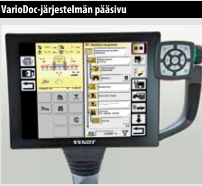
VarioDoc Pro antaa tarkat sijaintitiedot peltorekistereihin. Koneen tiedot, kuten moottorin kierros-luku, polttoaineen kulutus tai voimanoton kierrosnopeus, voidaan rekisteröidä kaikista sijainneista. Riippuen käytössäsi olevasta versiosta voit esimerkiksi tarkastella tehtyjä töitä graafisesti tietokoneella karttojen avulla, joissa on esitetty suhteellinen polttoaineen kulutus tai vaadittu vetovoima. Tämä on merkittävä etu verrattuna integroimattomiin jälkiasennusjärjestelmiin.
