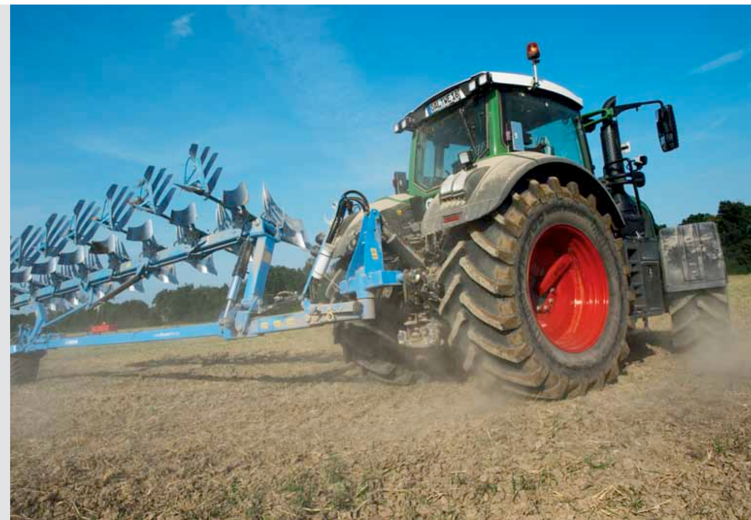
Variotronic TI -päisteautomaatiikan avulla kuljettaja voi luoda ja tallentaa traktorin päistekäännökset helposti traktorin seisoessa tai liikkeessä. Moottorin ja voimansiirron ohjauksen, hydrauliventtiilien, etu- ja takanostolaitteen, etu- ja takavoimanoton ja automaattiohjauksjärjestelmän sekä niiden yksittäisten toimintojen asetukset määritetään päisteautomaatiikan kautta. Sen jälkeen kaikki toiminnot ovat helposti haettavissa käyttöön.
