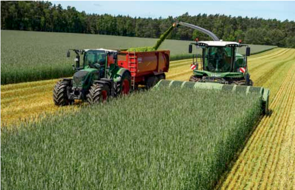
VarioGuide-automaattiohjaus Fendt Katana – ajosilppurissa
