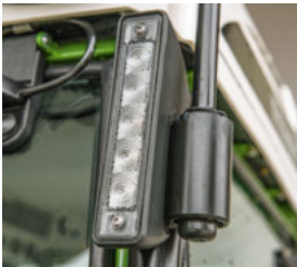
□ Suunta- ja seisontavalot on integroitu siististi A-pilariin.
