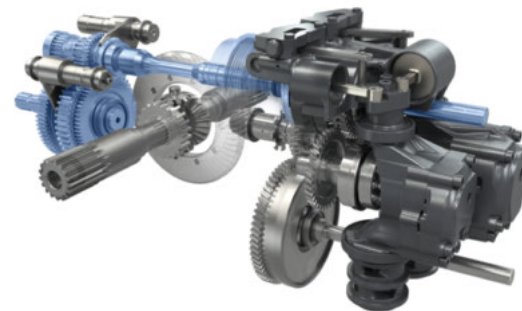
Voimanoton suora veto varmistaa erinomaisen tehokkuuden. Nopeutta alennetaan suoraan voimanottoakselilla.
