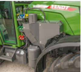
□ Kaksipiirinen paineilmajarrujärjestelmä on vakiona.
