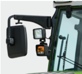
□ Sivustaustapeilit voidaan pyynnöstä asentaa irrotettaviksi.
