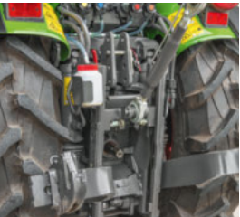
□ Pikanoston ansiosta työkonene ei laahaa maassa rinteissä, kun ajetaan riviin.
