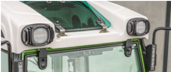
□ Katon etuosassa olevilla kirkkailla LED-työvaloilla on pitkä kantama.
