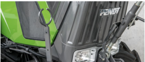
□ Kummallakin puolella olevien kiinnikkeiden ansiosta hydrauliletkut ovat aina siistejä ja vailla sotkuja.
