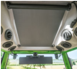
■ Kattoikkunan aurinkosuojia suojaa häikäsevältä auringonvalolta.
