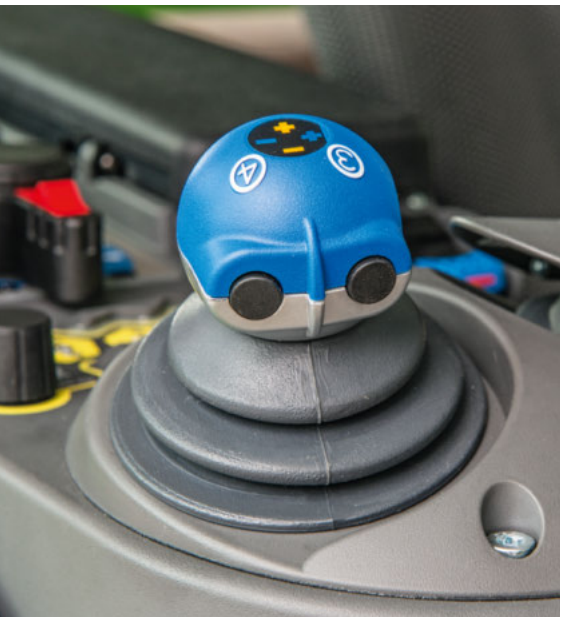
■ Ohjauspiirit 3 ja 4 aktivoidaan kätevästi sähkötoimisen ristivivun painikkeella tai kytkimellä.
