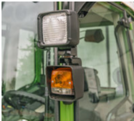
□ A-pilariin integroidut työvalot antavat lisää valoa ympäristöön ja suojaavat kasveja.
