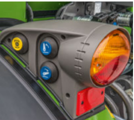
■ Hydrauliiikan ja voimanoton ulkoiset hallintalaitteet ovat takalokasuojissa.
