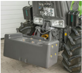
□ Etupään paino parantaa etuakselin voimansiirtotoimintoa.
