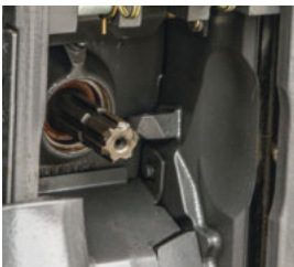
■ Voimanottoakselien kytkeminen on todella helppoa viistetyn profiilin ansiosta.
