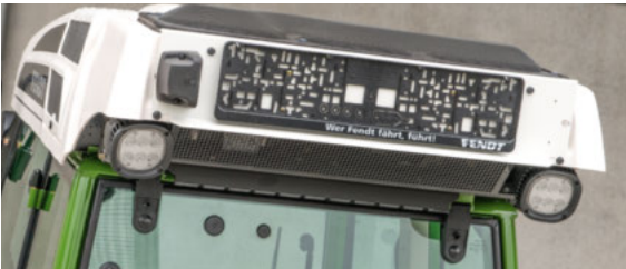
□ Seuraa katon takaosassa olevia työkoneita LED-työvaloilla.
