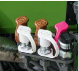
□ Hydrauliiikan yhdyslinja estää löysät letkut konepeiton yläpuolella.
