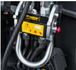
Monitoimipikaliitin vakiona työkonene nopeaan kiinnitykseen ja irrotukseen
