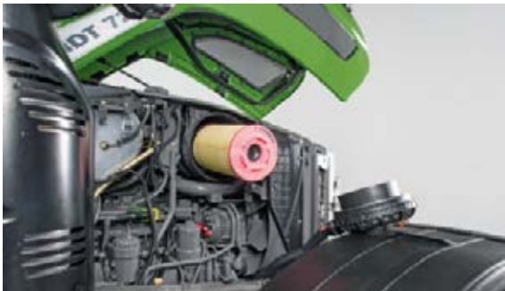
Ylös kääntyvä konepelti ja irrotettavat sivupaneelit tarjoavat erinomaisen pääsyn moottoritilaan. Tämä tarkoittaa, että ilmasuodatin voidaan poistaa nopeasti ja helposti.
