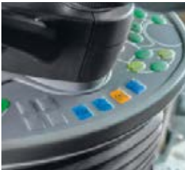
Kalvonäppäimistö työlaitteen lukituksen ohjaukseen ja vaimennuksen kytkentään.
