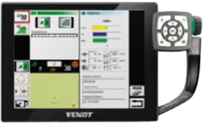
Vario-päätte tiedottaa seuraavista huoltopäivämääristä, ja siinä on myös muistutustoiminto.
