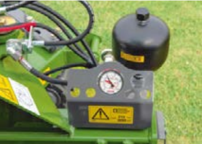
Leikkuupalkin hydropneumaattisen TurboLift-kevennyksen ansiosta niittäminen tapahtuu kevyesti yhdellä kertaa.
