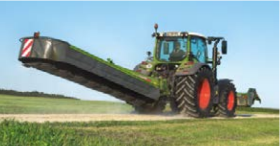
Kuljetusasennossa niittokone kääntyy 90° taakse ohjaamosta operoiden.
