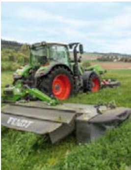
Keskelle kiinnitetty niittokone seuraa hyvin maanpintaa.
