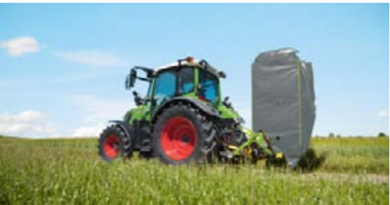
Vaihto työskentelytilasta kompaktiin kuljetusasentoon sujuu mukavasti ja kätevästi suoraan ohjaamosta.
