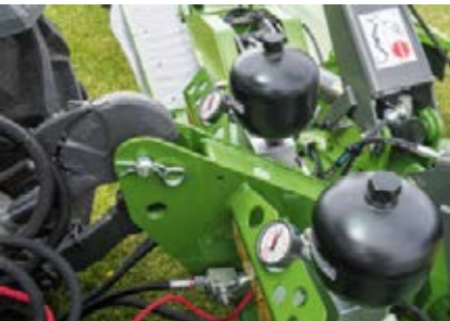
Painemittarin avulla TurboLift-järjestelmän maakosketuspainetta voi seurata koko ajan ja paineen voi säätää ohjaamosta käsin.
