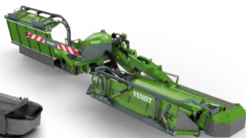
Niittokoneyhdistelmät ISOBUSilla Täydellinen automatisointi kuljetusmatolla Työleveys 9,30 m
