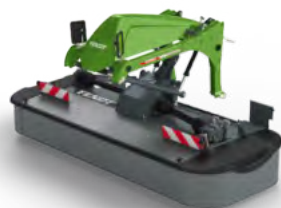
Etuniittokoneet 3D-vetopukilla Ihanteellinen niittokoneyhdistelmässä Työleveys 3,10 – 3,60 m
