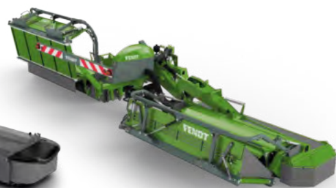
Niittokoneyhdistelmät ISOBUSilla Täydellinen automatisointi kuljetusmatolla Työleveys 9,30 m
