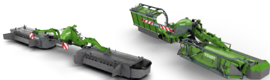
Niittokoneyhdistelmät ilman ISOBUSia Kevyt ja helppovetoinen Profi-iskuvoima Työleveys 8,30 – 9,60 m
