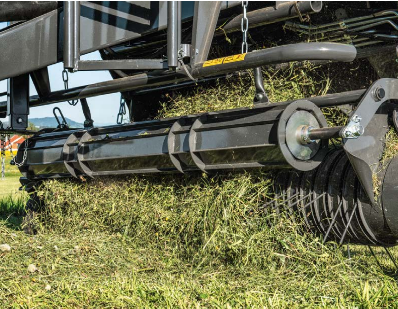
Kiinteäpiikkinen noukin on sekä helppo huoltaa että tasaisesti käyvä.
