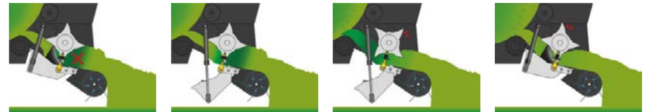
Tukkeutumistilanteessa leikkuupöydän takaosa laskeutuu 500 mm.
