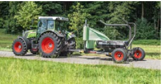
Käytännöllistä: Rollector 130 -käärijän telineeseen mahtuu jopa kolme kalvorullaa.
