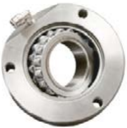
Joustavat laakerit estävät liian suuret aksiaaliuormitukset pidentäen huomattavasti käyttöikää.
