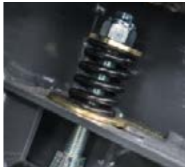
FlexControl-jousi vaimentaa leikkuupöydän etuosasta tulevat kuormitushuiput estäen näin tukokset.
