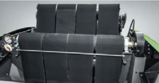
Neljä symmetrisesti järjestettyä hihnasilmukkaa muodostavat paalin. Hihnat saavat käytön kahdelta käyttötelalta juuri sopivan voiman siirtämiseksi.
