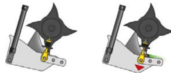
FlexControl-kuormankevennysjärjestelmä estää luotettavasti tukokset.
