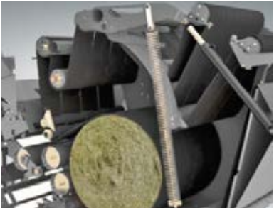
Hihnaa pyöritetään kahden edessä sijaitsevan hihnanjohtotelan avulla. Hihnan kaksinkertainen kulku telojen ympäri saa aikaan ehdottoman luotettavan paalin pyöryksen kaikilla paalityypeillä.
