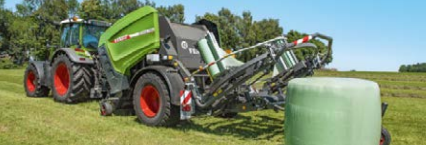
Pystyyn käännettäessä paalit jäävät pystyyn pellolle, josta ne voidaan kuljettaa pois nopeasti ja helposti.
