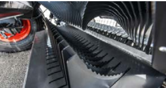
Rotana 160VXtra- ja 180VXtra-mallien hydrauliseen teräryhmään voi kuulua 0, 12, 13 ja 25 terää.
