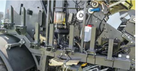
Muovikalvoa ei enää tarvitse asettaa 12 kalvonpidikkeeseen. Rullat asetetaan helposti pakkauksessaan yksittäisiin taivutuihin piikkeihin.
