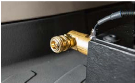
Puhdista ohjaamo nopeasti käytännöllisen paineletkuliittännän ansiosta.
