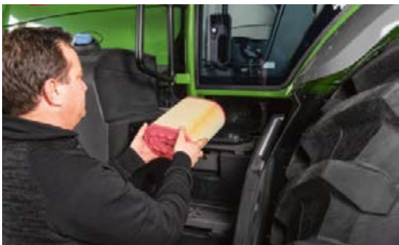
Sisäänkäynnin lähelle sijoitettu ohjaamon ilmansuodatin on helppo puhdistaa tarvittaessa.
