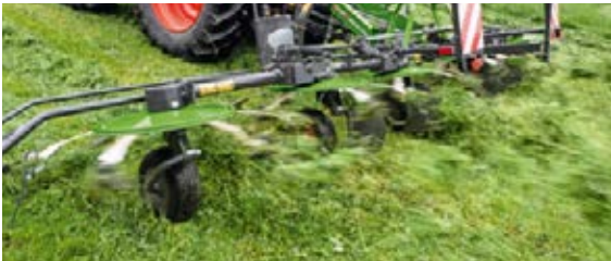
Kiertymisenestojärjestelmä estää satoa kiertymästä pyörän akselin ympärille.
