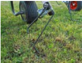
Rehu noukitaan Fendt Performance -piikkien 7,5 cm:n pitkällä koukulla.
