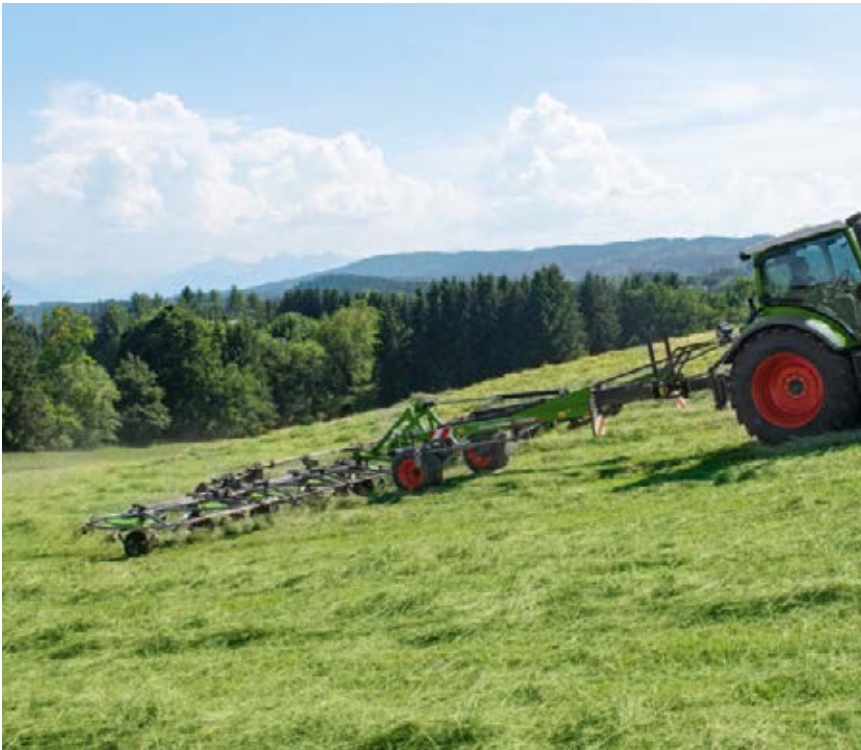
Levitä koko työleveydelle: roottorien välissä on useita palloniveleitä varmistamassa, että jokainen mukautuu maaperään erikseen. Vähäinen kuluminen ja puhdas syöttö, takuulla.
