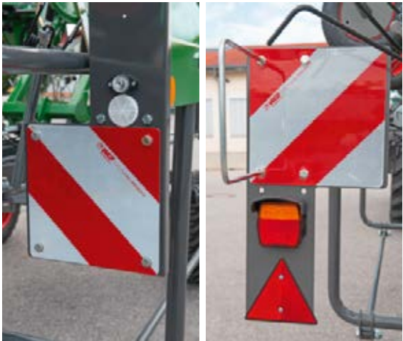
Parempaa liikenneturvallisuutta varten kiinnitettävissä Lotus-malleissa on erikoissuuret varoitusmerkit, ja ne seuraavat päävalaistuksen toimintaa vakiona.
