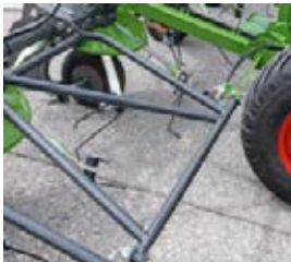
Perävaunupöyhimissä on lisäristikkorunko maksimaalista vakautta varten päärungon suojaamiseksi ja vahvistamiseksi koko koneen leveydeltä.
