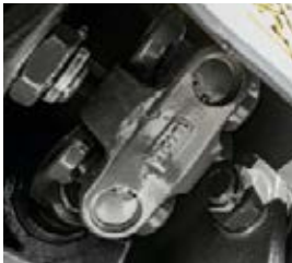
Huoltovapaat kaksoisristinivelet varmistavat suoran voiman siirron ja tarkoittavat, että pöyhin voi kääntyä myös taitetussa kuljetusasennossa.
