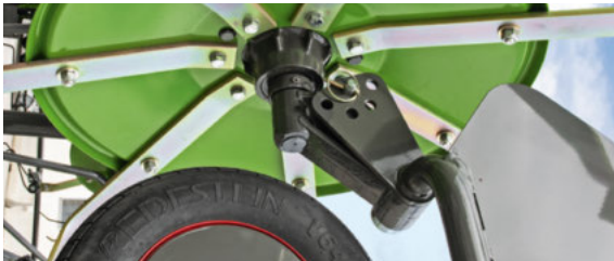
Säädä levityskulman asentoa helposti yhtä pulttia siirtämällä. Valittavana on 5 asetusta 10°–17° – tarkasti sovitettu tarpeisiisi joka kerta.
