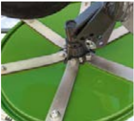
Suuret roottorilevyt tarkoittavat, että piikkien nopeus pysyy suurena alhaisella roottorin nopeudella.
