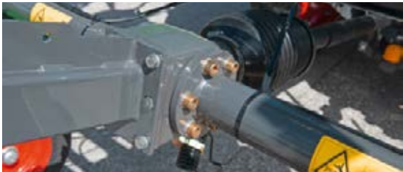
Pääkäyttöakselin ylikuormasuoja parantaa käyttöluotettavuutta ja tekee Lotus-pöyhimen voimansiirrosta erittäin kestävän.
