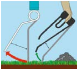
Suuren joustavuutensa ansiosta laahaavat Fendt Performance-piikit voivat myös välttää esteitä paljon helpommin kuin perinteiset piikit. Piikkien rikkoutuminen ei ole ongelma Lotuksessa.
