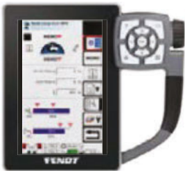
Ristivivun ja punnitusjärjestelmän näyttö: osapaino ja kokonaispaino sekä aisaston ja työkonteen työalueen rajoitus.
