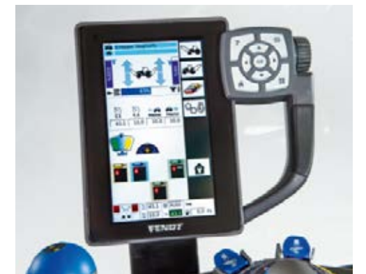
Vario-pääte tiedottaa seuraavista huoltopäivämääristä, ja siinä on myös muistutustoiminto.
