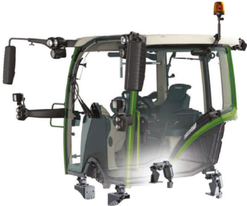
□ Ohjaamon ilmajousitus (Profi- ja ProfiPlus-kokoonpano) vähentää tärinää ja tarjoaa erinomaisen ajomukavuuden. Tasonsäädöllä varustettu ohjaamo on tuettu neljästä pisteestä: edessä kahdella kartiolaakerilla ja takana kahdella ilmajousielementillä.
