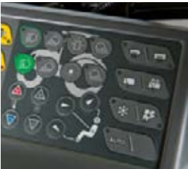
■ Ilmastointi varmistaa hyvän jäähdytyksen ja työskentelymukavuuden. Power-mallissa on manuaalinen ilmastointi; Fendt 300 Vario Profi- ja ProfiPlus -malleihin on saatavana täysautomaattinen ilmastointi lisävarusteena.
