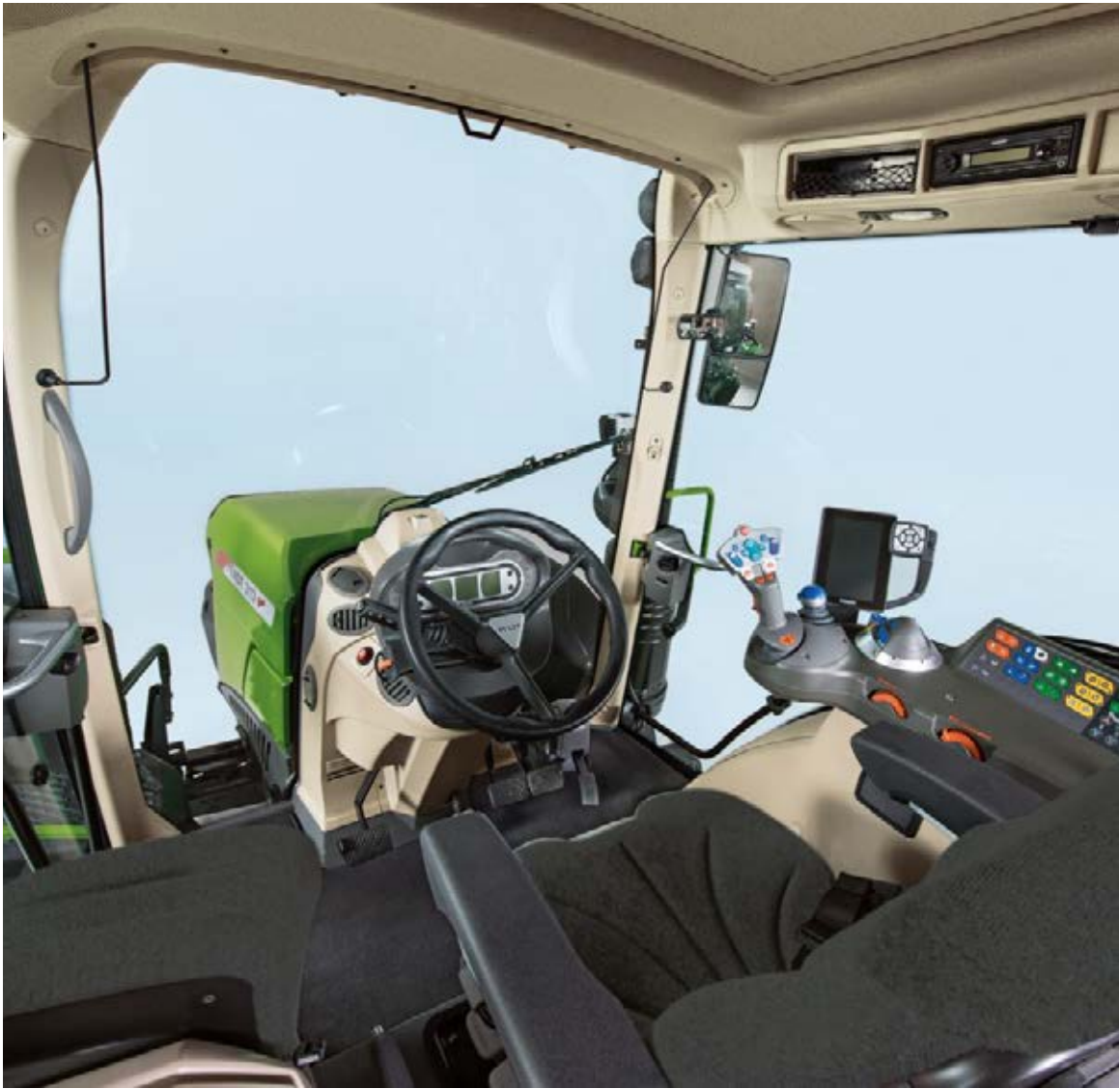
Selkeästi ja ergonomisesti järjestetty VisioPlus-ohjaamo tarjoaa parhaan näkyvyyden sekä hallintalaitteisiin että pellolle. Tuulilasi on saatavana yhtenäisellä panoraamaikkunalla tai saranoidulla ikkunalla. Oikealle puolelle voidaan asentaa myös ovi.
