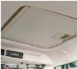
■ Kattoverhoiluun asennettu kattoluukku tarjoaa lisäilmastointia kuumina päivinä.
