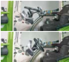
Kuljettajan istuma-asento saadaan optimaaliseksi säätämällä ohjauspyörän korkeutta ja kaltevuutta. Ohjauspyörää ja mittaristoa voidaan säätää erikseen.
