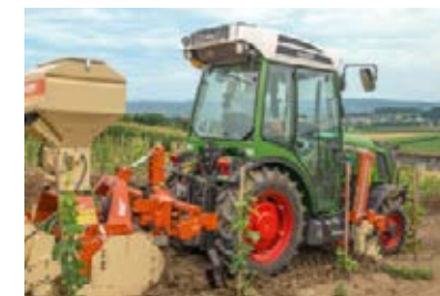
Väliakselikiinnitys joustavien työkoneyhdistelmien tehokasta käyttöä varten.
