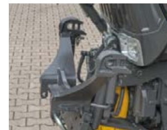
Etuhydrauliikan alavarret voidaan taittaa nopeasti pieneen kokoon.
