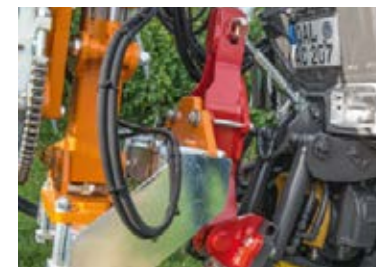
Etunostolaitteeseen integroidut kiinnityspalkit tarjoavat aina vakaan ja turvallisen ja vakaan alustan raskaille eteen kiinnitettävälle työkoneelle.
