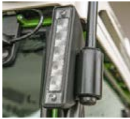
□ Suunta- ja seisontavalot on integroitu siististi A-pilariin.
