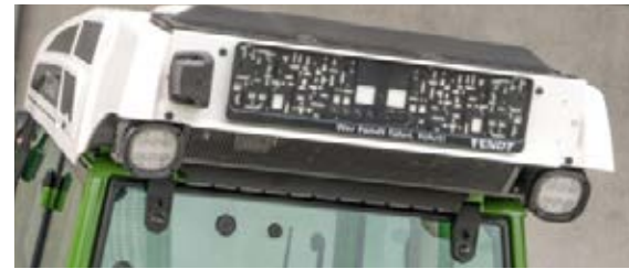
□ Seuraa katon takaosassa olevia työkoneita LED-työvaloilla.
