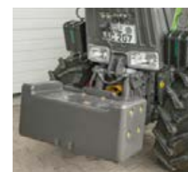
□ Etupään paino parantaa etuakselin voimansiirtotoimintoa.
