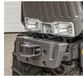
□ Jos etunostolaitetta ei käytetä, lisävastapaino voidaan valinnaisesti kiinnittää suoraan runkoon.
