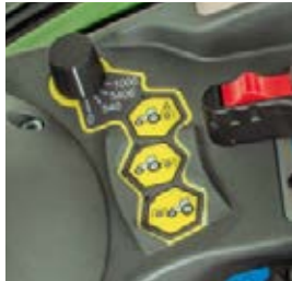
Kätevä voimanoton mukavuuskäytin automaattitoiminnolla kynnärnojassa.
