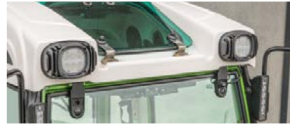
□ Katon etuosassa olevilla kirkailla LED-työvaloilla on pitkä kantama.
