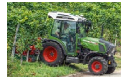
Voimanotot toimivat ajonopeudesta riippumatta. Voit esimerkiksi ajaa hitaasti, kun muokataan tiheää leikkaamatonta kasvustoa, ja ajaa nopeammin jatkuvasti vaihdetta vaihtamatta tai sammuttamatta harvassa kasvustossa.
