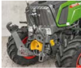
P-vaihtoehdon etunostolaitteen nostokyky on 2 540 daN.
