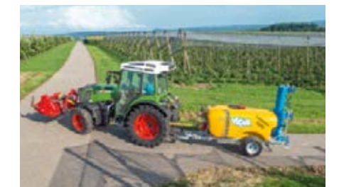
Tehokas prosessien yhdistelmä. 540E/750-etuvoimanoton kanssa voit ajaa silppuria käyttönpeudella, vaikka ruisku takana ja traktori toimivat alennetulla käyntinopeudella.
