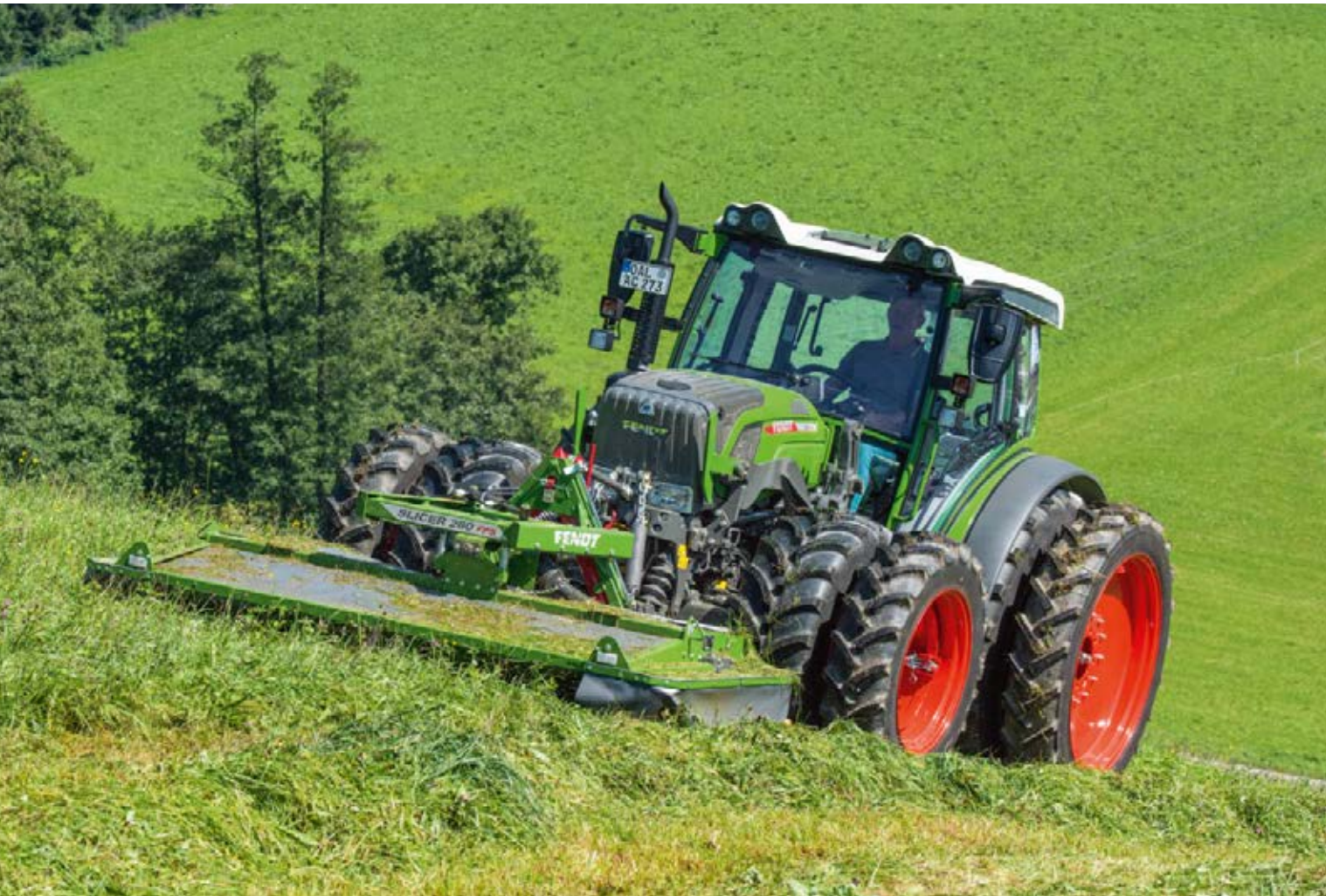
Turvallisesti ja ilman kulumista, ja nouse takaisin ohjaamoon myös rinnemaastossa raskailla kuormilla: Fendt Vario -voimansiirron aktiivisen pysähdyksenhallinnan ansiosta kaikki toimii ilman nykimistä.
