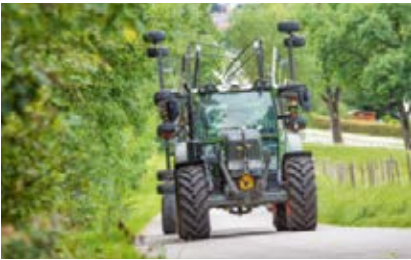
Traktori kulkee tasaisella maalla pienemmällä nopeudella. Rinteessä TMS nostaa moottorin käyntinopeutta ja säättää vaihteiston suhdetta. Heti kun vetovoiman tarve pienenee, TMS laskee moottorin käyntinopeuden mahdollisimman polttoainetehokkaalle alueelle.
