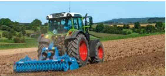
Voit työskennellä oikealla voimanoton kierrosnopeudella ajonopeudesta riippumatta ajonopeuden ja moottorin nopeuden itsenäisen ohjauksen ansiosta.
