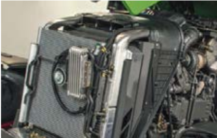
Polttoaineen lisjäähdytin tehostaa toimintaa.
