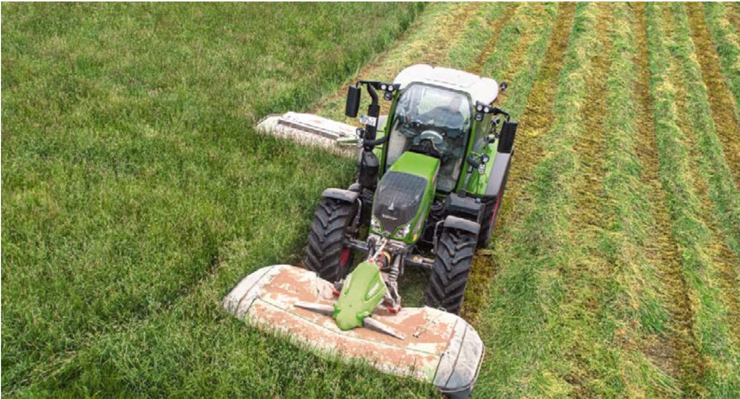
Fendt Vario on hydromekaaninen voimansiirto. Nopeuden noustessa planeettavaihteiston kautta siirtyvän mekaanisen voiman osuus kasvaa. Hyvästä tehokkuudesta huolehtivat jopa 45 astetta kääntyvät, korkealla 550 barin maksimityöpaineella toimivat hydrostaatit.
