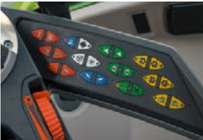
Voimansiirron toimintoja on helppo säätää kyynnärnojaista, esimerkiksi nopeuspolkimen aluetta kiertokytkimellä. TMS:n, nelivedon ja voimanoton pyörimisnopeuden valinta yhden painikkeen painalluksella.
