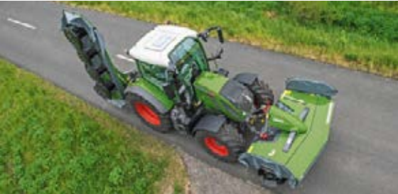
Fendt 500 Vario kiihtyy huippunopeuteensa 50 km/h alhaisella moottorin pyörimisnopeudella 1 700 r/min ja ajonopeuteen 40 km/h nopeudella 1 400 r/min.
