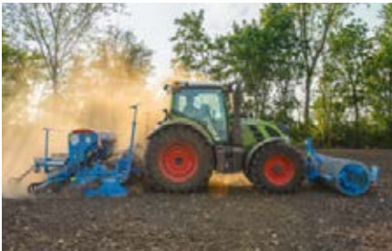
Suuri voimanoton teho suoraan moottorista voimanottoakselille siirtyvän voiman ansiosta.
