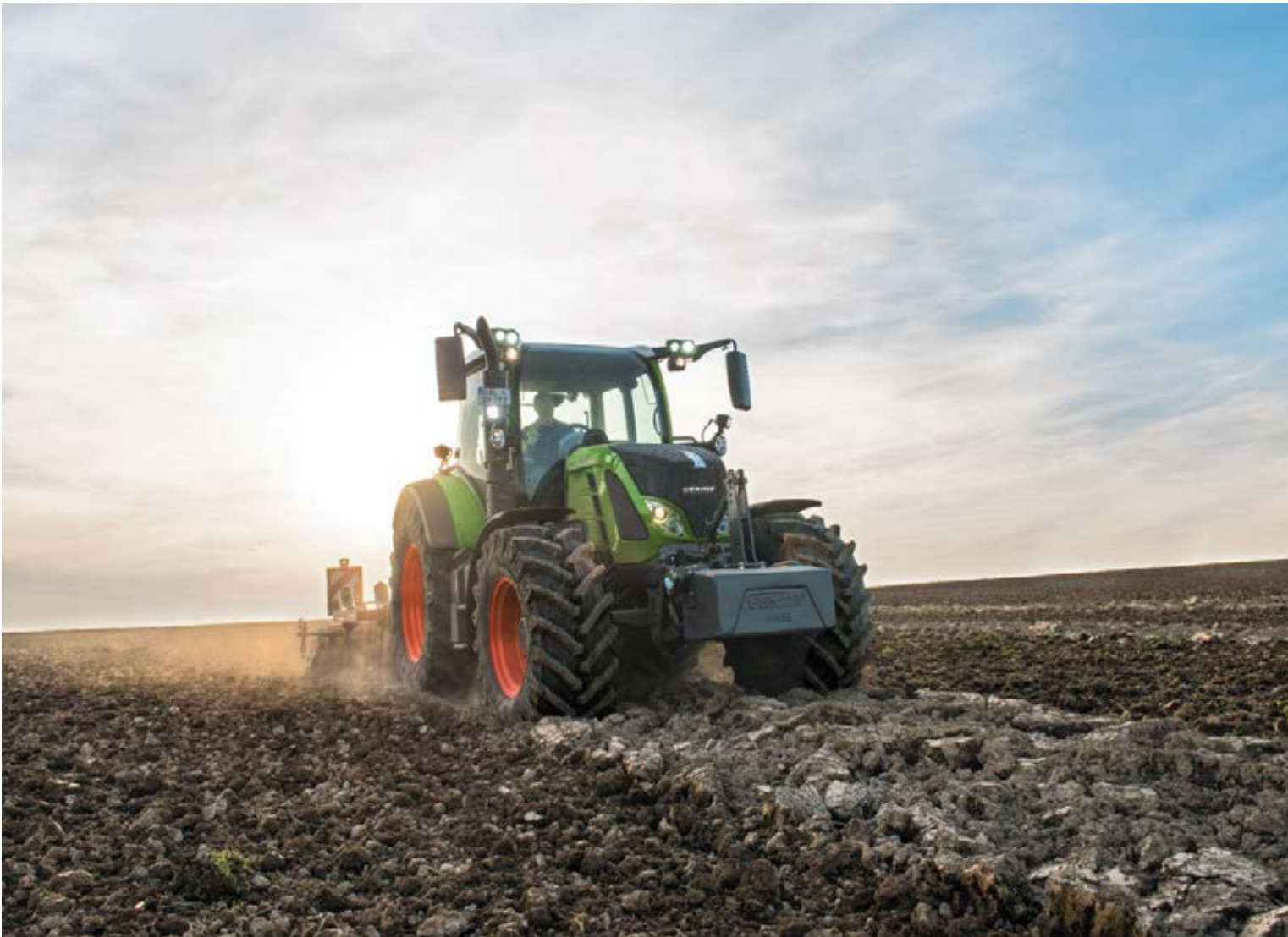
Moottorin ominaisuudet – Fendt 516 Vario Vääntö 699 Nm, maksimiteho 171 hv pyörimisnopeudella 1 900 r/min
