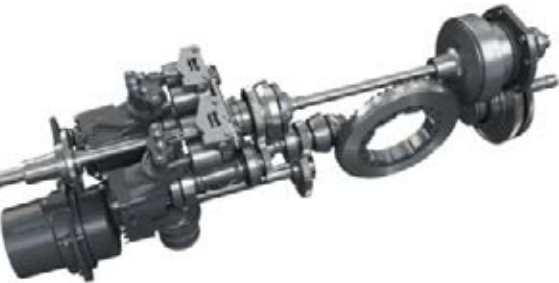
Fendt Vario on hydromekaaninen voimansiirto. Nopeuden noustessa planeettavaihteiston kautta siirtyvän mekaanisen voiman osuus kasvaa. Hyvästä tehokkuudesta huolehtivat jopa 45 astetta kääntyvät, korkealla 550 barin maksimityöpaineella toimivat hydrostaatit.
