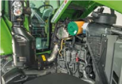
Esisuodattimen ansiosta Fendt 500 Varion ilmansuodatin on pitkäikäinen ja hyvin esillä huoltoa varten.
