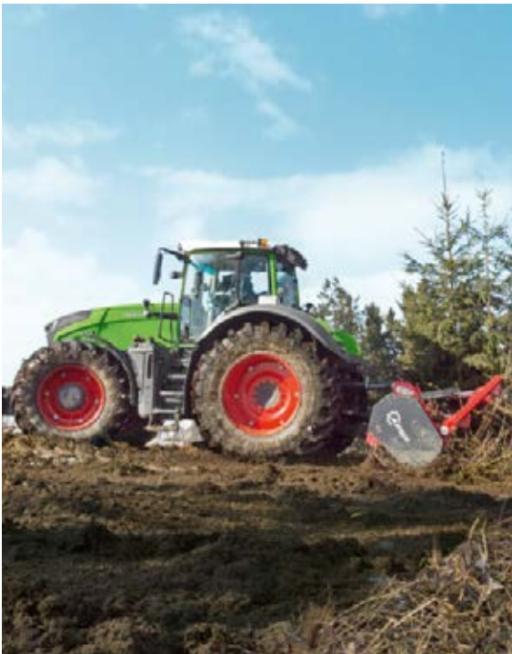
Taakseajotilassa kaikkia hallintalaitteita voidaan käyttää yhtä vaivattomasti kuin ajettaessa traktoria eteenpäin. Koko ohjausama kääntyy ympäri 180° – kaikki muu pysyy paikallaan ohjaamossa. Taakseajolaitteistosta huolimatta matkustajalle on myös istuin.
