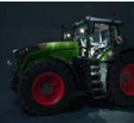
Kotiintulovalona toimivat ajovalot ja nousuportaiden valot jäävät palamaan moottorin sammuttamisen jälkeen, jolloin sekä kotiinmenotie että portaat ovat hyvin valaistut.
