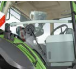
Sivuikkunan pyyhkijä, jonka pyyhintäalue on 220°, varmistaa lisäksi optimaalisen näkyvyyden oikealle puolelle myös hankalissa olosuhteissa.
