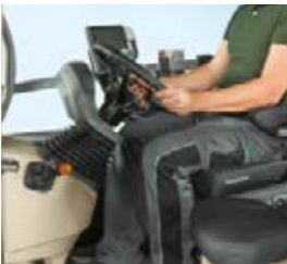
Mittaristo kääntyy ohjauspyörän mukaisesti parantaen käyttömukavuutta. Ohjauspyörä on helppo säätää erillisen jalkapolkimen avulla ilman käsien apua.
