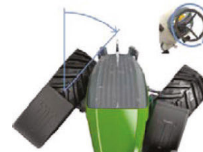
VarioActive-ohjausjärjestelmän ansiosta pyörät saa täyteen kääntökulmaan yhdellä ohjauspyörän kierroksella.
