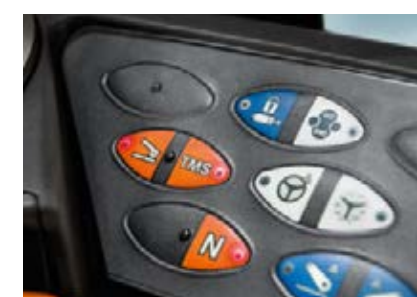
Kaikki toiminnot on järjestetty selkeästi taustavalaistulle kalvonäppäimistöille käytännössä testatun Fendt-toimintalogiikan mukaisesti.
