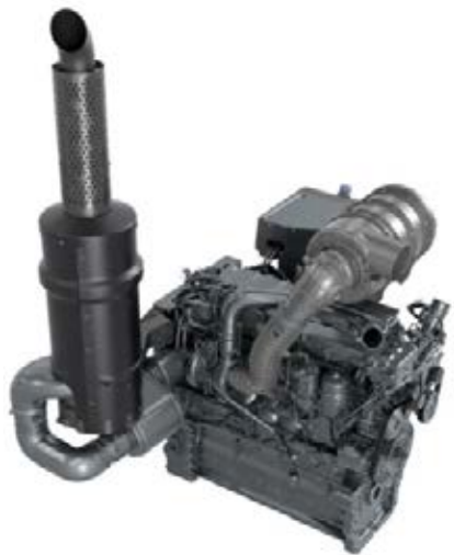
Common Rail -yhteispaineruiskutukseen perustuvan 12,4-litraisen MAN-moottorin ruiskutusaine on korkeat 1800 baria.
