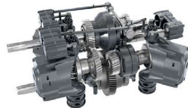
Uudet tehokkaat, suurikokoisemmat (370 cm³) hydrostaattit varmistavat erittäin tehokkaan voimansiirron. Erillinen öljypiiri suojaa voimansiirtoa öljyn sekoittumiselta ja likaantumiselta.
