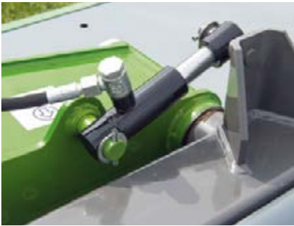
Kompensointisylinteri vakauttaa niittokoneen päästeellä ja tiellä.
