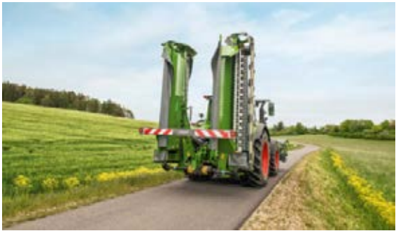
Kokoontaitettuna niittokoneyhdistelmän korkeus on alle 4 metriä, jolloin sitä on helppo kuljettaa alhaalla sijaitsevan painopisteen ansiosta.
