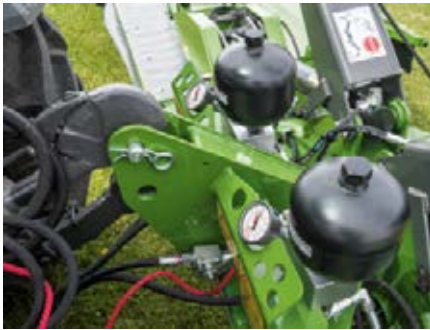
Painemittarin avulla TurboLift-järjestelmän maakosketuspainetta voi seurata koko ajan ja paineen voi säätää ohjaamosta käsin.
