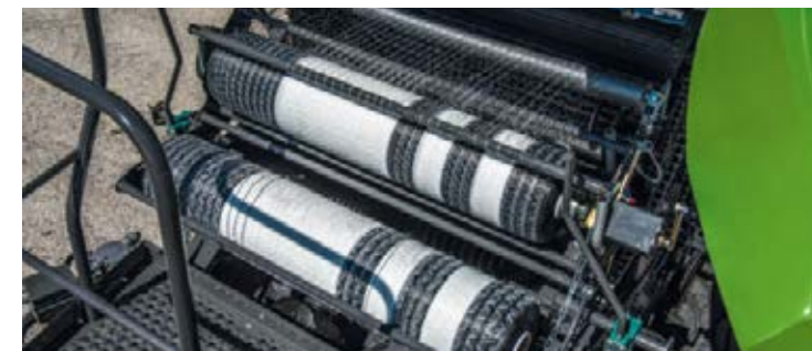
EasyLoad-järjestelmän ansiosta verkkorullien lisääminen sujuu erittäin nopeasti.
