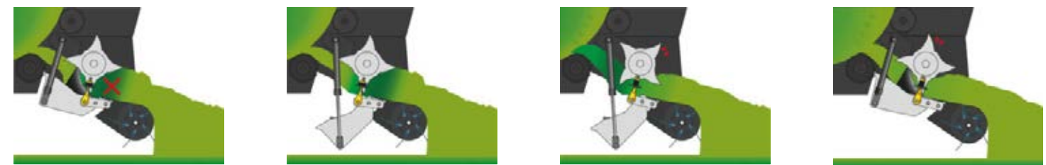
Tukkeutumistilanteessa leikkuupöydän takaosa laskeutuu 500 mm.
