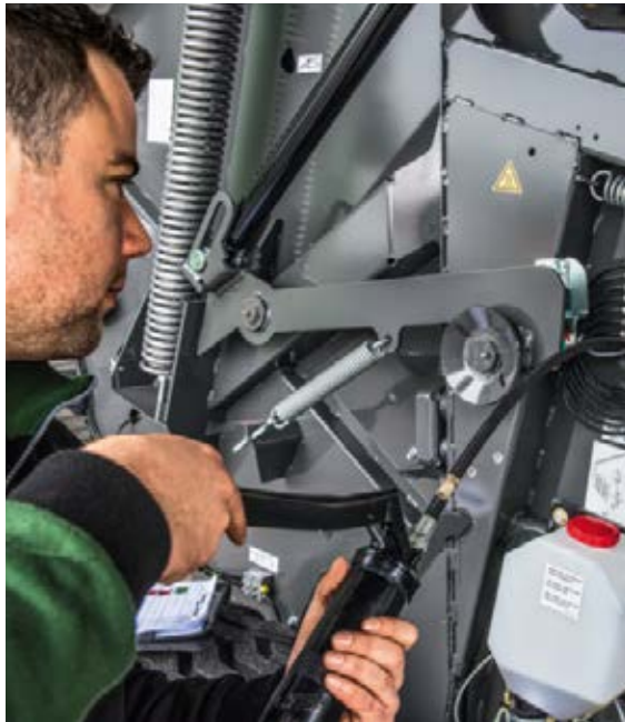
■ Voitelukohteet on yhdistetty yhteen helpottamaan järjestelmän voitelua.
