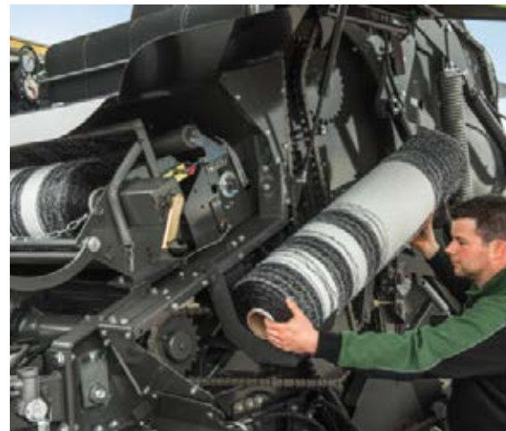
■ Verkkorullat on nopea ja helppo asettaa pysäköintiasentoon, jotta paaliverkkoa on aina riittävästi saatavilla.
