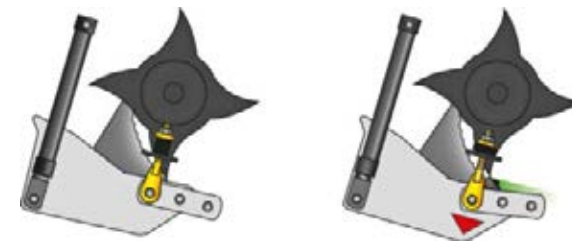
FlexControl-kuormankevennysjärjestelmä estää luotettavasti tukokset.
