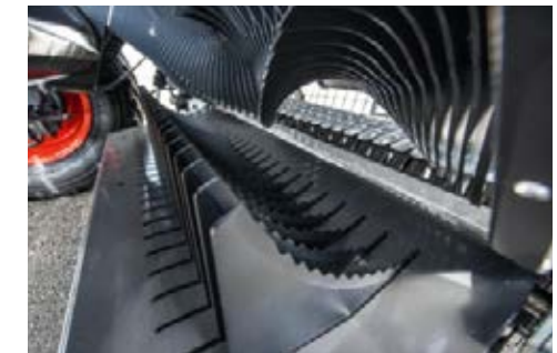
4160 V Xtra- ja 4180 V Xtra -mallien hydraulinen teräryhmä sisältää 0, 12, 13 ja 25 terää.
