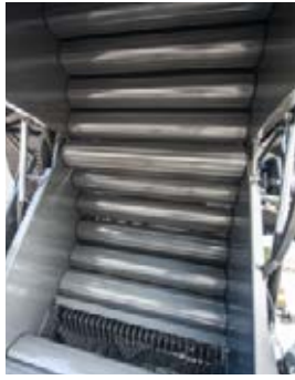
PowerGrip-terästelöiden kolme sälettä koskettaa jatkuvasti paalia varmistaen luotettavan pyöriksen.
