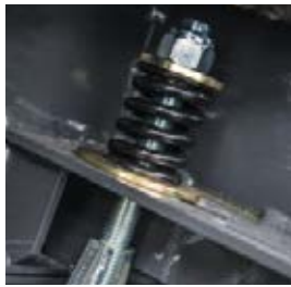
FlexControl-jousi vaimentaa leikkuupöydän etuosasta tulevat kuormitushuiput estäen näin tukokset.
