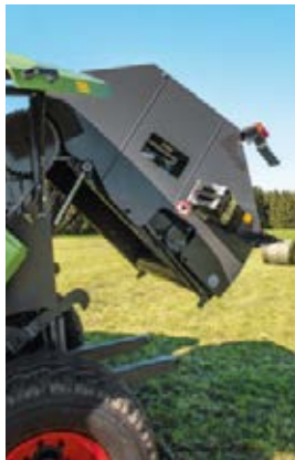
Takaluukussa oleva tappi varmistaa luukun luotettavan sulkeutumisen myös rinne- ja maastossa.
