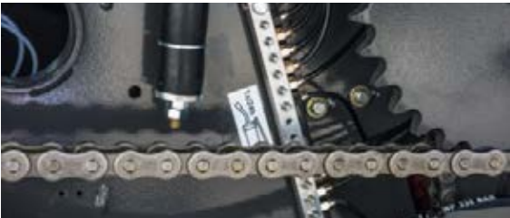
■ Ketjujen voiteluöljyn määrä on yksilöllisesti säädettävissä.
