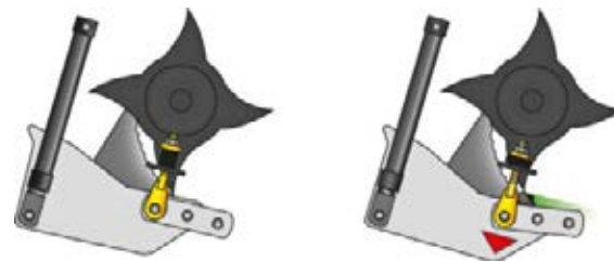
FlexControl-kuormankevennysjärjestelmä estää luotettavasti tukokset.
