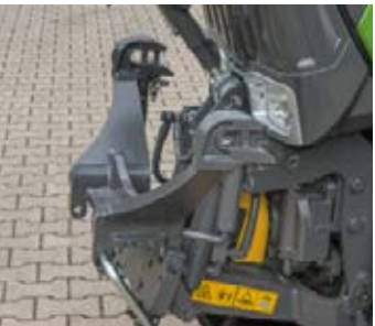
Traktoriin asennetun etuhydrauliikan alavarret taittuvat kätevästi kokoon muutamalla työvaiheella. Kompakti rakenne tekee 200 Vario -traktorista erittäin helposti ohjattavan myös työkone eteen kiinnitettynä.
