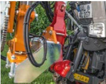
Etunostolaitteeseen integroidut kiinnityspalkit tarjoavat aina vakaan ja turvallisen ja vakaan alustan raskaille eteen kiinnitettävälle työkoneille.
