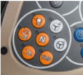
VarioActive-automaattiohjausjärjestelmä ja opastusjärjestelmä voidaan aktivoida ohjauspyörän konsolista.
