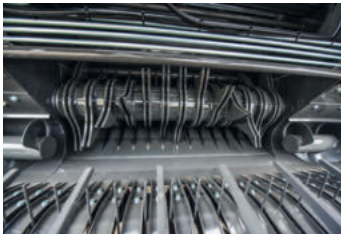
Xtracut13-roottori (Sormiparivälili: 90 mm) - Ilman leikkuuyksikköä (sarja) - Leikkuuyksikön kanssa: jopa 13terää
