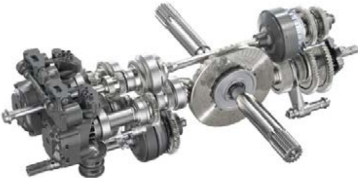
Fendt Vario on hydromekaaninen voimansiirto. Nopeuden noustessa planeettavaihteiston kautta siirtyvän mekaanisen voiman osuus kasvaa. Poikkeuksellisesta tehokkuudesta huolehtivat jopa 45 astetta kääntyvät ja 550 barin maksimityöpainella toimivat hydrostaattit.
