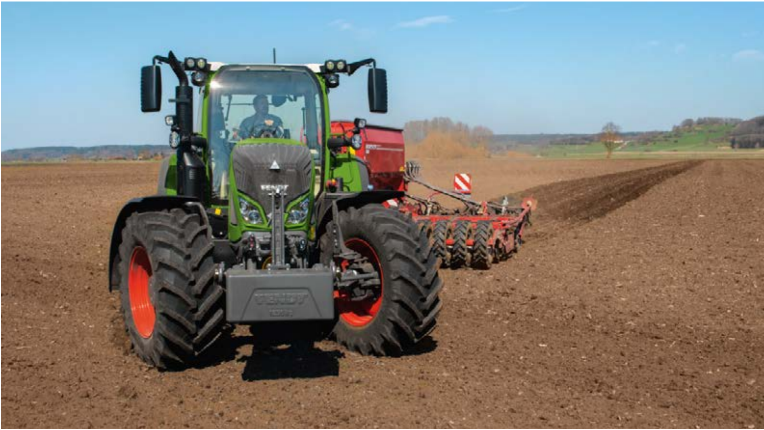
Huippumalli, Fendt 724 Vario, saavuttaa maksimiväännön 1 072 Nm jo moottorin pyörimisnopeudella 1 500 r/min.
