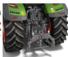
Quick Hitch -kehys, jossa on vakiona lukituskoukkujen hydraulinen avaus
