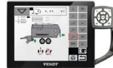
Vous trouverez aisément la position optimale des déflecteurs pour la vidange avec le système de déchargement automatique. Réglez individuellement la vitesse du fond mouvant.
