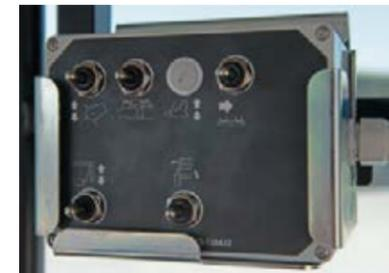
La commande confort électrique permet de contrôler toutes les fonctions directement depuis la cabine.
