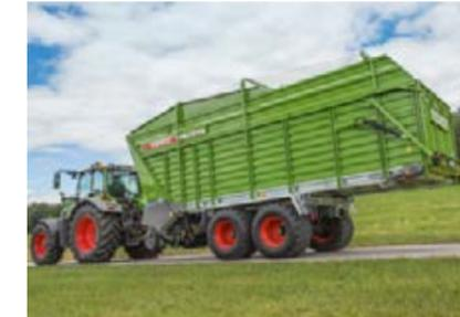
Tous les modèles Tigo MS et MR ont un poids maximum admissible de 12 t. Vous pouvez décider de passer à 15 t sur les modèles Tigo MS et 17 t sur les modèles MR et MR Profi.
