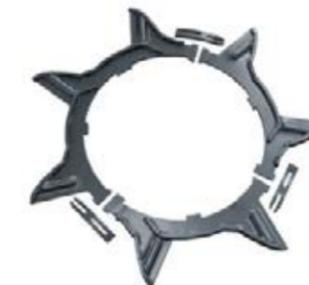
Les dents du rotor se composent de trois éléments et peuvent être retirées séparément. Trois nouveaux éléments sont verrouillés, pour pouvoir les remplacer facilement, puis soudés trois fois avec des butées individuelles.
