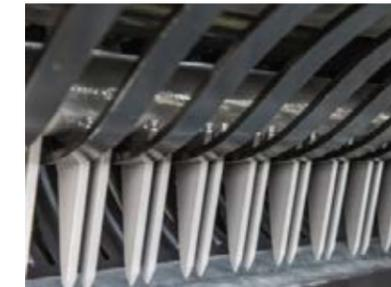
Les peignes en une seule section permettent de garantir un débit de fourrage régulier et homogène.
