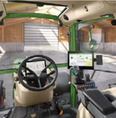
Profi+ Setting 1 - Avec levier en croix - 2 modules linéaires (fingertips) – pour commander les distributeurs hydrauliques - Terminal 12"
