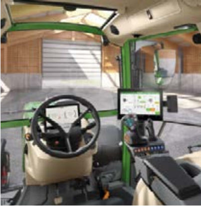
Profi Setting 2 - Joystick 3L - 2 modules linéaires (fingertips) – pour commander les distributeurs hydrauliques - Terminal 12"
