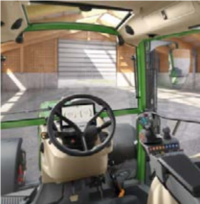
Profi Setting 1 - Avec levier en croix - 2 modules linéaires (fingertips) – pour commander les distributeurs hydrauliques
