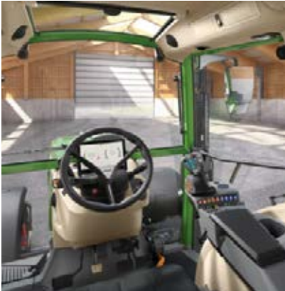
Power Setting 1 - Sans levier en croix - 2 modules linéaires (fingertips) – pour commander les distributeurs hydrauliques
