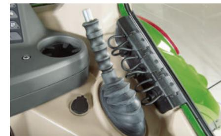
Fendt propose une solution intelligente pour les câbles en provenance de l'arrière du tracteur qui pénètrent dans la cabine. Les câbles peuvent être acheminés par le passe-câbles, quel que soit leur diamètre. Le conducteur peut fermer la vitre arrière pour empêcher la poussière, les impuretés, l'eau et le bruit de pénétrer à l'intérieur.
