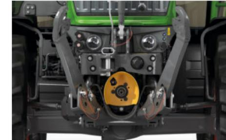
Les raccords hydrauliques à l'arrière sont parfaitement alignés et se repèrent facilement grâce à leur code couleur. Les volets anti-poussières se ferment automatiquement. Le système d'accouplement sous pression permet de raccorder les distributeurs hydrauliques en charge, ce qui facilite l'attelage et le dételage des outils.
