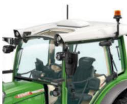
Parfaitement protégé, le récepteur Fendt Guide est intégré dans le toit du tracteur. Sans composants et câbles extérieurs apparents, cette technologie protège non seulement le récepteur contre les branches basses, mais également contre le vol.
