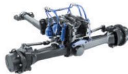
Le système de mise à niveau intégré à la suspension d'essieu avant garantit un confort de travail et de conduite constant, quelle que soit la charge. La fonction verrouillage assure un guidage ultra précis des outils lors de l'utilisation au chargeur frontal, par exemple pour le chargement de palettes.
