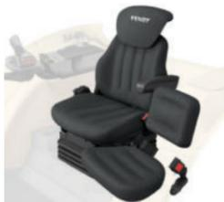
Le nouveau siège confort 30 mm plus large, avec 20 mm de suspension en plus et support lombaire mécanique, offre une assise d'un extrême confort. Pour gagner de la place, vous pouvez faire pivoter le siège passager rembourré haut pour l'escamoter.
