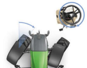
Que vous soyez en bout de champ ou que vous sollicitiez le chargeur frontal, la direction FendtActive\* vous permet d'accomplir un angle de braquage complet avec un seul tour de volant. Jusqu'à 8 km/h, il suffit d'un seul tour de volant pour pouvoir braquer à fond. Entre 8 et 18 km/h, l'effet de la direction à amplification variable diminue progressivement.
