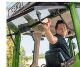
La poignée verticale de la lunette arrière est une spécificité du Fendt 200 Vario qui permet d'ouvrir et fermer simplement la fenêtre, tout en restant assis.
