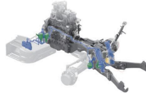
Le relevage avant est parfaitement intégré au demi-châssis, flasqué au tracteur. Cela permet aux machines attelées d'être extrêmement maniables. Les bras inférieurs se distinguent par une grande course et se replient facilement pour le transport. Des soufflets protègent les vérins de relevage des projections. L'amortisseur par boule d'azote installé de série évite les à-coups et offre une sécurité ainsi qu'un confort de conduite exceptionnels.
