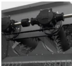
L'option d'inversion hydraulique des rotors, pilotée depuis la cabine, permet de déboucher rapidement le cas échéant..
