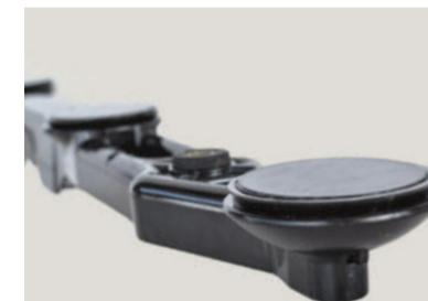
Les capteurs de pertes installés à l'extrémité du caisson aident le conducteur à régler la machine sur la meilleure configuration possible, en signalant les pertes de céréales au sol par un affichage sur l'écran de travail
