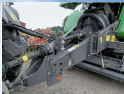
*La boule d'attelage orientée vers l'arrière améliore la maniabilité. Il manque un support pour les flexibles.*
