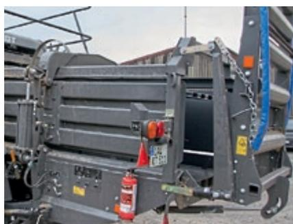
L'éjecteur et la rampe de déchargement se commandent à l'arrière. La balance est intégrée à la rampe, le dispositif de mesure de l'humidité est au-dessus.
