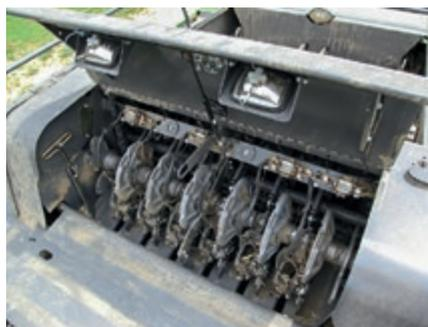
Un ventilateur tangentiel (de série !) fait régner la propreté parmi les doubles noueurs. Le graissage centralisé des noueurs est lui aussi de série.
