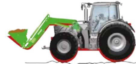
**Chargeur frontal doté d'un système d'amortissement :**
