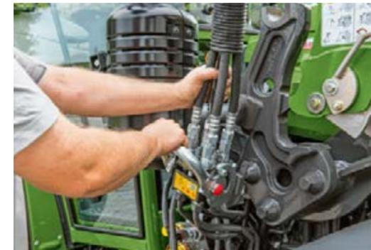
Le nouveau Cargo-Lock de Fendt permet d'atteler et de déteiler le chargeur facilement et rapidement. Le multicoupleur permet lui aussi de gagner du temps. Il permet à toutes les conduites électriques et hydrauliques d'être raccordées d'un seul geste.
