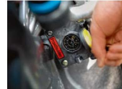
Les capteurs desservant les fonctions du CargoProfi se trouvent à droite du chargeur frontal, parfaitement protégés.
