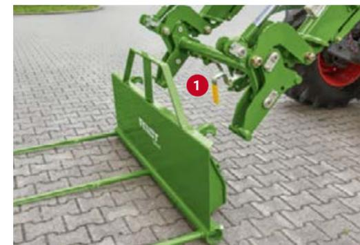
L'outil se déverrouille facilement à l'aide d'un levier (1) sur le cadre d'attelage rapide, d'un seul geste. Lors du montage d'un outil, il est possible de le verrouiller automatiquement en le basculant complètement.
