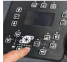
Le panneau de commande OptiFlow vous permet de contrôler facilement l'incorporation des produits phytosanitaires.
