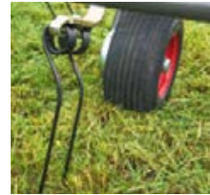
Les dents Super C sont constituées d'acier robuste de 9,5 mm d'épaisseur et se distinguent par leur longévité et leurs résultats extraordinaires.
