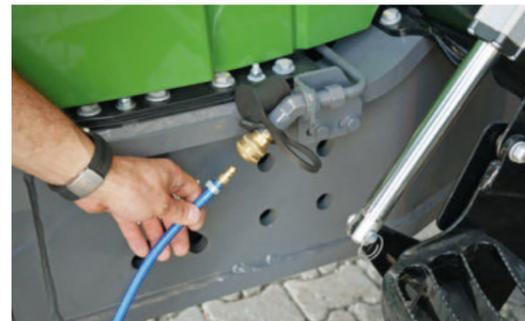
Il y a un raccord d'air comprimé à l'avant de la machine pour nettoyer les radiateurs.
