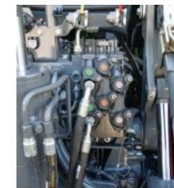
Le circuit hydraulique est conçu pour offrir les meilleures performances et vous permet de disposer d'une option de débit de 440 l/min à 1700 tr/min.
