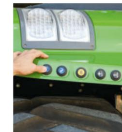
Actionnez le relevage arrière, la PDF et un distributeur confortablement depuis les ailes arrière.
