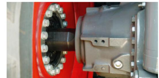
Le robuste pont arrière a été conçu pour garantir une durée de vie maximale. Le niveau d'huile interne peut être facilement contrôlé par les jauges transparentes.
