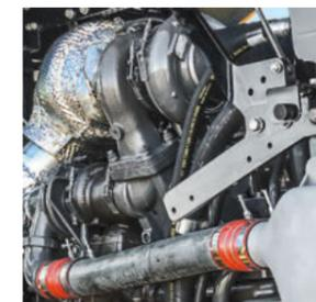
Deux turbocompresseurs à géométrie fixe et une soupape Wastegate à commande électronique distribuent un couple considérable sur toute la plage de régime moteur.
