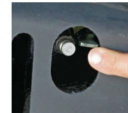
□ La pression de tension de la chenille peut être réglée confortablement en se branchant sur un raccord hydraulique facilement accessible sur le côté.
