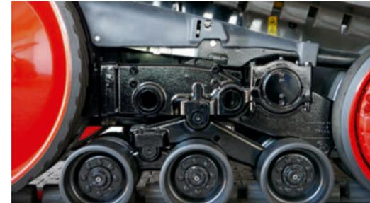
Grâce au concept de suspension innovant SmartRide, le Fendt 900 Vario MT offre un confort de conduite inégalé pour un tracteur à chenilles.
