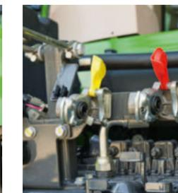
Le freinage pneumatique double ligne agit également sur la remorque quand le frein de stationnement est activé.
