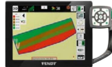
Modulation de dose Variable Rate Control : quantités flexibles appliquées en fonction des cartes d'application ou capteurs en ligne, notamment un capteur N-sensor.
