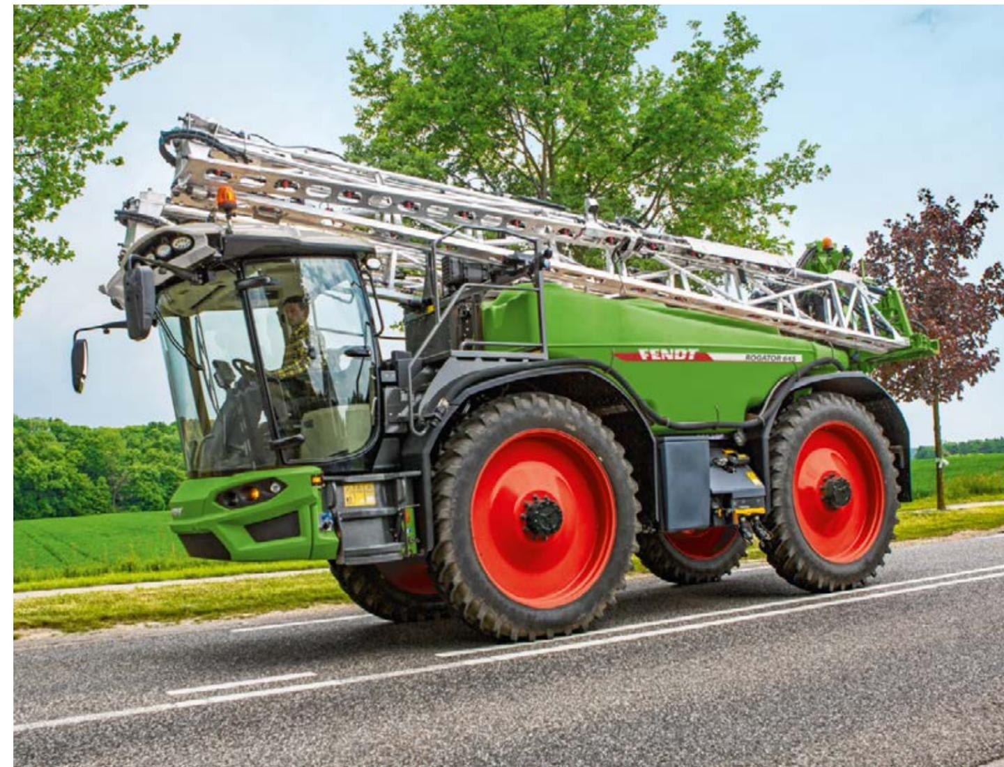
Compact et maniable au champ, sûr et rapide sur route : la tenue de route exceptionnelle du Rogator 600 se ressent au champ. Avec une largeur extérieure de seulement 2,55 m et jusqu'à 16 t de charge tractée, aucun problème pour atteindre vos parcelles, même les plus reculées.
