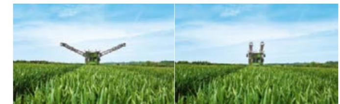
Le contour du terrain ou les cultures peuvent servir de référence pour le contrôle de la hauteur, afin d'adapter la rampe avec précision selon vos exigences. Un contrôle combiné est également possible.
