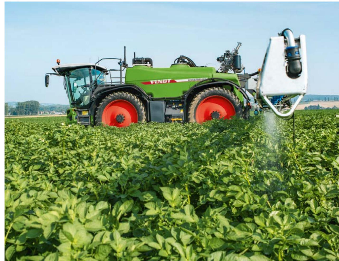
Avec un débit de pompe maximum de 785 l/min, l'application d'engrais liquide est simple comme bonjour. L'entraînement hydraulique de la pompe rotative ne capte que la puissance effective nécessaire, ce grâce au CDS. Le Fendt Rogator l'entraîne toujours à la vitesse la plus basse possible dans la gamme la plus efficace.
