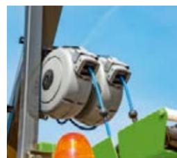
□ Enrouleur de flexible, pour un nettoyage facile de l'extérieur de la machine.
