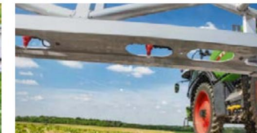
La protection contre les impacts du Fendt Rogator peut pivoter jusqu'à 90°. Les mouvements de pivotement vers l'arrière sont amortis afin qu'aucune impulsion supplémentaire n'agisse sur la rampe.
