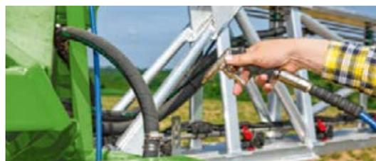
□ Le pistolet pneumatique en option se situe à l'arrière de la rampe et permet un nettoyage rapide.
