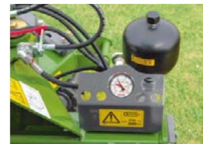
Le délestage hydropneumatique du lamier TurboLift permet une coupe parfaite.
