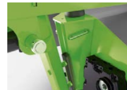
Le système de suivi breveté assure un guidage optimal du lamier.
