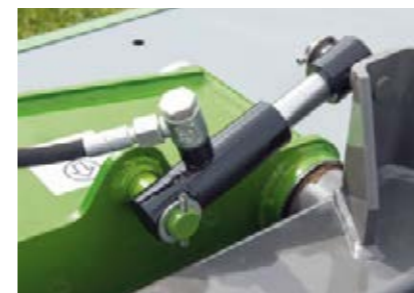
Le vérin de compensation stabilise la faucheuse en bout de champ et sur route.
