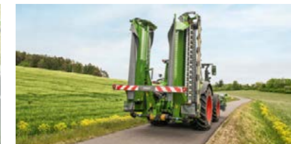
En position repliée, la combinaison de faucheuses reste à une hauteur inférieure à 4 m et peut être conduite grâce à son centre de gravité bas.
