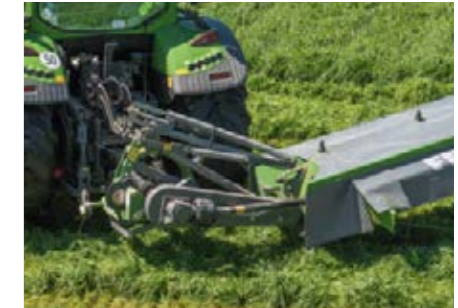
Le montage à ressorts assure une faible pression au sol et protège le tapis végétal.
