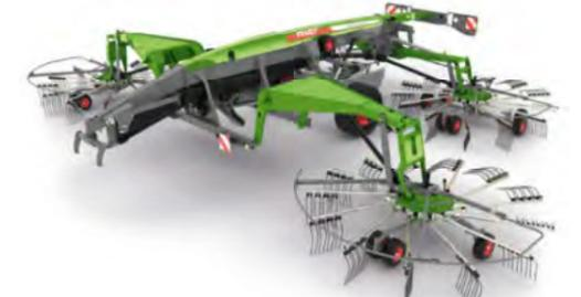
**Andaineur quatre rotors avec châssis de transport**
