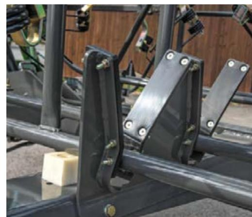
■ Les groupes faneurs de la Twister, qui sont équipés de paliers longue durée, s'intègrent parfaitement aux supports spéciaux en V sur le châssis. (Sur la version châssis de la Fendt Twister uniquement.)
