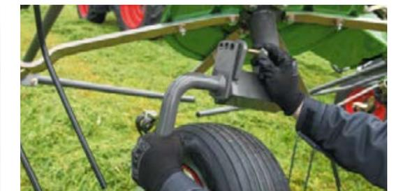
L'angle d'éparpillage est facile et rapide à régler à 15, 18 et 21° grâce à la présence d'un gabarit sur les roues.
