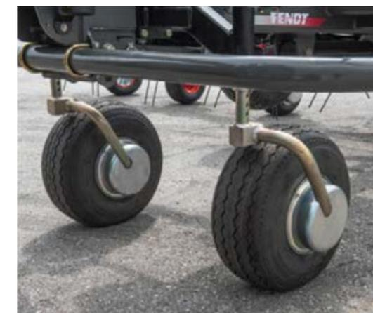
□ Les roues d'appui mobiles en option optimisent le suivi du terrain et garantissent un ratissage propre et une protection de l'herbe. (Fendt Twister 901 T)
