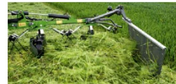
Sur la faneuse haut de gamme Twister 11010 DN, le fanage en bordure s'effectue à l'aide de la toile de fanage en bordure repliable, hydraulique, disponible en option.
