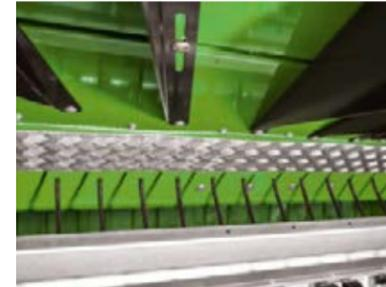
Distribution sur mesure du fourrage, grâce au dispositif de fanage standard, réglable sans outil.
