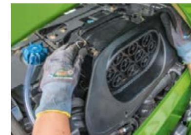
Un accès aisé, comme illustré ici avec le remplacement du filtre à air, est une caractéristique de tous les tracteurs Fendt Vario et aide à écourter les interventions d'entretien.
