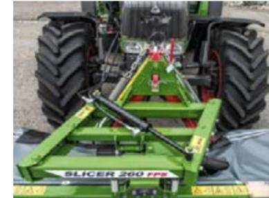
Deux ressorts assurent que la faucheuse est toujours centrée au milieu ; le flottement est empêché de manière fiable durant le transport et en fourrière.
