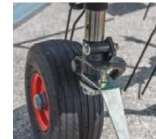
Le dispositif d'éparpillage en bout de champ de série se règle rapidement et facilement en utilisant un levier sur les roues des toupies.
