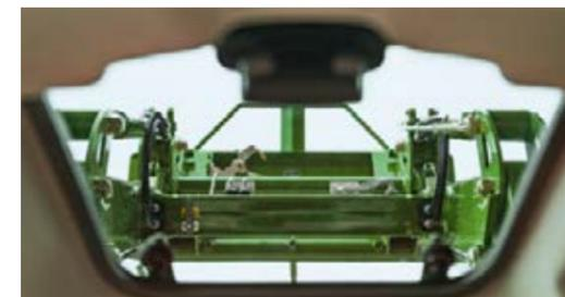
Le Fendt 200 Vario est équipé de série d'un toit vitré offrant une visibilité optimale sur le chargeur frontal. Vous pouvez également relever la fenêtre de toit pour permettre une ventilation supplémentaire de la cabine. Un pare-soleil intégré protège des rayons intenses du soleil.
