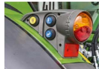
Commande externe du relevage et la prise de force arrière. Cette fonction facilite l'attelage des outils à l'arrière et vous évite de vous déplacer, par exemple pour remplir votre tonne à lisier.
