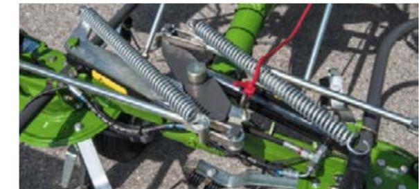
Le relevage synchronisé est garant de sécurité lors du relevage de la faneuse dans les terrains en pente.
