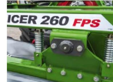
L'ensemble tracteur-outil se déplace sans danger, même en terrain pentu, car le point d'accouplement est proche du tracteur.
