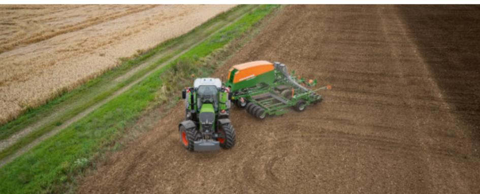
„ Mais ce qui nous a encore plus impressionnés, c'est sa manoeuvrabilité. Grâce à l'effet << pull-in-turn >> de la transmission intégrale automatique, le diamètre de braquage mesuré ne dépassait pas 12,25 m (VF600/ 70 R 30 avec 1,98 m de voie) – très bien!“
