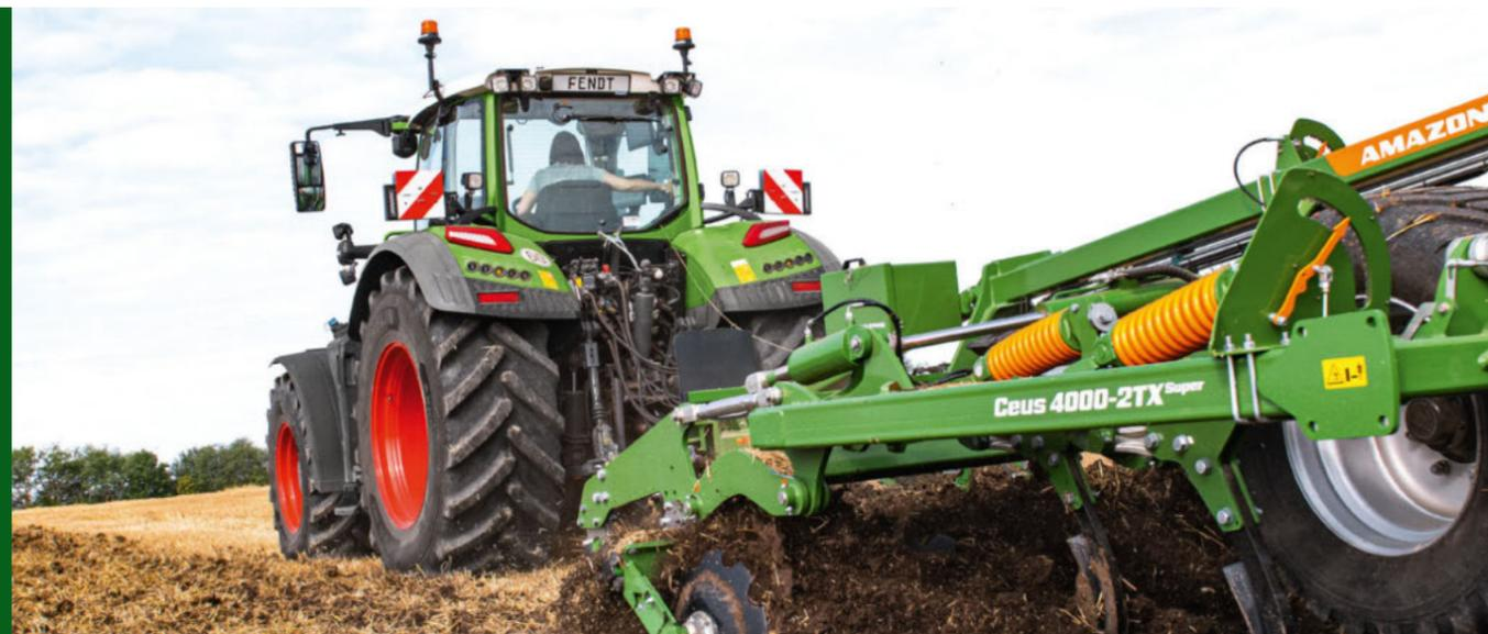
” Concernant la puissance exprimée à la prise de force, l'aiguille s'est figée à 203 kW au régime nominal, avec un maximum de 206 kW à 1 500 t/min. Par rapport à la puissance maximale de 223 kW avec la DP, c'est une valeur très appréciable. Il en va de même pour le couple maximal de 1 364 Nm (à 1 300 tr/min).“
