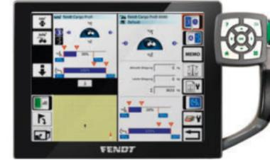
Le terminal Vario et l'ordinateur de tâches sur le chargeur frontal sont connectés par la prise CargoProfi.
