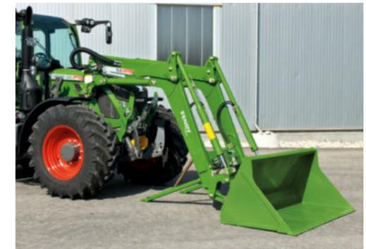
Le Fendt Cargo-Lock est le garant d'un montage et d'un démontage rapides et faciles. Un multicoupleur permet de raccorder toutes les conduites hydrauliques et électriques à la fois, même si elles sont sous pression du côté du chargeur frontal.
