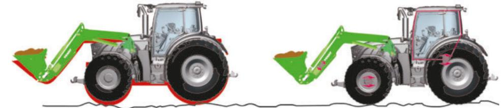
**Chargeur frontal doté d'un système d'amortissement :**
