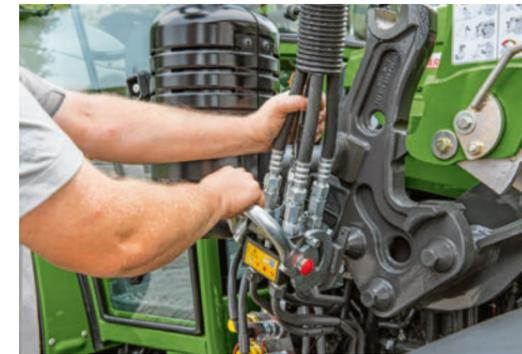
Le nouveau Cargo-Lock de Fendt permet d'atteler et de dételé le chargeur facilement et rapidement. Le multicoupleur permet lui aussi de gagner du temps. Il permet à toutes les conduites électriques et hydrauliques d'être raccordées d'un seul geste.
