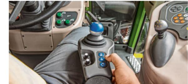
Que vous soyez en bout de champ ou que vous sollicitiez le chargeur frontal, la direction VarioActive vous permet d'accomplir un angle de braquage complet avec un seul tour de volant. Jusqu'à 8 km/h, il suffit d'un seul tour de volant pour pouvoir braquer à fond. Entre 8 et 18 km/h, l'effet de la direction à amplification variable diminue progressivement.
