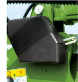
Deux capteurs de pression logés dans la traverse permettent d'activer la fonction de pesage du CargoProfi.
