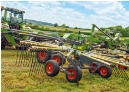
Lors de la descente en bout de champ, ce sont les roues arrière qui entrent en premier en contact avec le sol, puis celles avant. Lors du relevage, les rotors sont soulevés à l'avant en premier. Cet effet Jet protège le tapis végétal.
