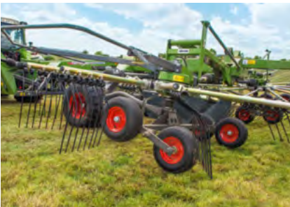
Lors de la descente en bout de champ, ce sont les roues arrière qui entrent en premier en contact avec le sol, puis celles avant. Lors du relevage, les rotors sont soulevés à l'avant en premier. Cet effet Jet protège le tapis végétal.
