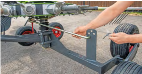
Que le fourrage soit long et lourd ou court et léger : le chemin de cames peut être ajusté facilement en fonction des conditions de récolte.
