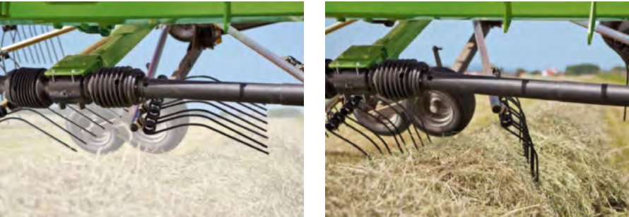
Sur la gauche, vous pouvez voir les dents soulevées par le CamControl. L'andain est protégé par l'impressionnante garde au sol. L'image sur la droite montre un système conventionnel, laissant un andain endommagé.
