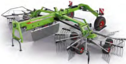
Andaineur deux rotors a andain central avec châssis de transport
