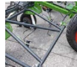
Les faneuses trainées disposent d'un cadre supplémentaire pour une stabilité hors pair. Ce dernier protège et renforce le châssis principal sur toute la largeur de la machine.
