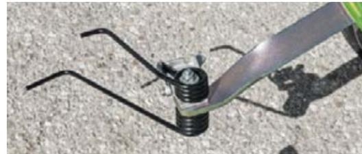
La fixation spéciale des dents à angle d'inclinaison modifiable facilite le passage au dispositif de fanage en bordure de champs ou la création d'andains de nuit tout en évitant les pertes de dents.
