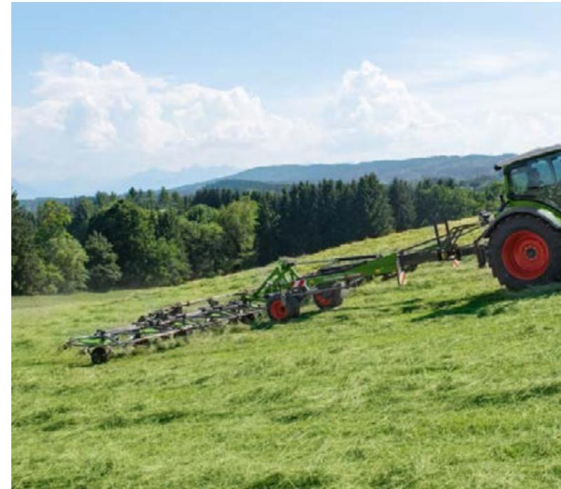
Réparties sur toute la largeur de travail, les nombreux joints articulés entre les toupies permettent à chacune d'elles de suivre avec précision les contours du terrain. Faible usure et répartition optimale du fourrage garantis.
