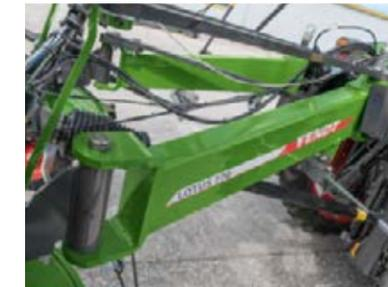
Pour le transport, les toupies sont repliées par commande hydraulique et fixées à l'aide d'un dispositif mécanique.
