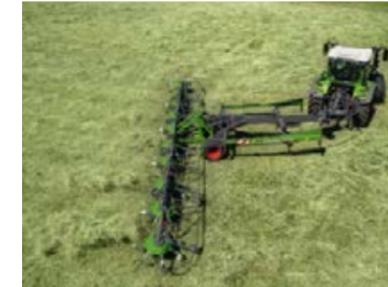
Profondeur de travail configurable. Facilement accessible, la manivelle permet d'ajuster avec précision la hauteur de fanage.
