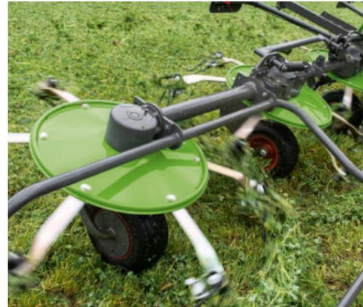
Pneus volumineux sur chaque toupie pour un fonctionnement fluide optimal et une excellente adaptation au sol.
