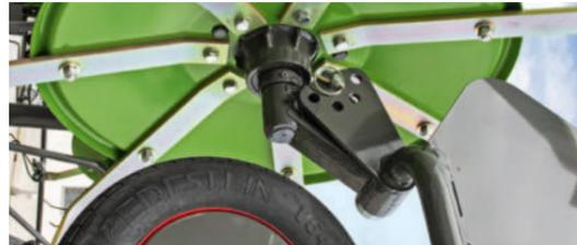
Réglage aisé de l'angle de travail grâce à un simple axe verrouillé par une goupille. Vous avez le choix entre 5 réglages différents, de 10° à 17°, précisément adaptés à vos besoins spécifiques.
