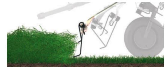
Comme la roue est proche des dents, la machine s'adapte merveilleusement aux contours du terrain.
