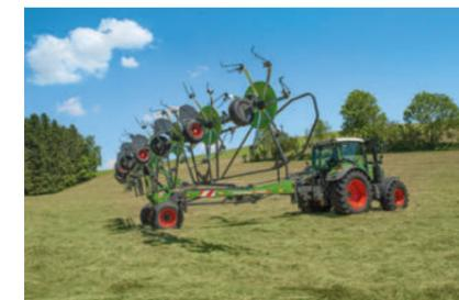
Pour le transport sur route, les toupies sont repliées sur le châssis. Cela préserve les articulations, puisque la sollicitation est réduite lorsque les toupies sont repliées. Cette position de transport particulière (toupies alignées les unes derrière les autres) signifie que même les plus grands modèles Lotus sont suffisamment compacts pour le transport.
