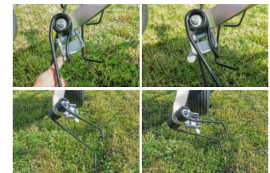
Un simple ajustement des dents sur la toupie extérieure active le dispositif de fanage en bordure. Cette opération permet de ramener les dents en position intérieure en laissant une bordure de champ parfaitement propre et en répartissant le fourrage de manière optimale.
