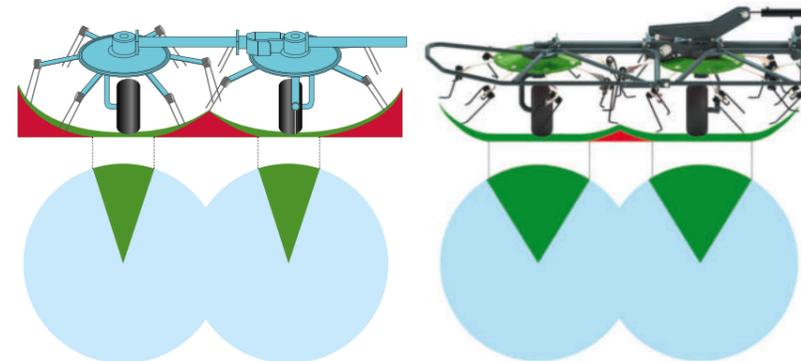
L'angle d'inclinaison et la grande flexibilité des dents Performance Fendt leur permettent de glisser sur le terrain sans abîmer le couvert végétal. Comparées à des dents traditionnelles, elles bénéficient d'une plus grande portée de projection, ce qui permet de couvrir une plus grande superficie.
