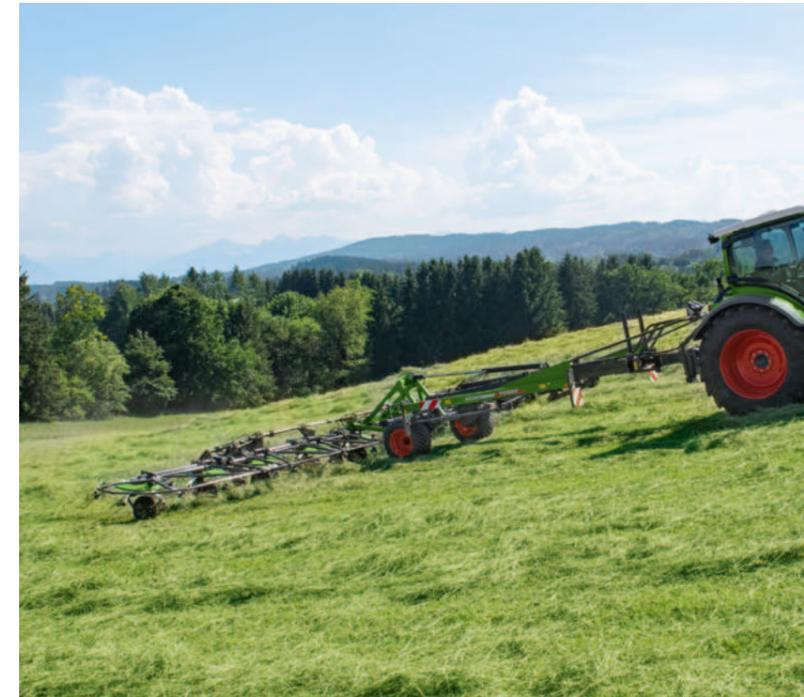
Répartis sur toute la largeur de travail, les nombreux joints articulés entre les toupies permettent à chacune d'elles de suivre avec précision les contours du terrain. Faible usure et répartition optimale du fourrage garantis.
