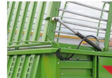
Alternativement, la superstructure pour fourrage sec peut être pliée et dépliée par commande hydraulique.
