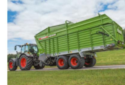
Tous les modèles Tigo MS et MR ont un poids maximum admissible de 12 t. Vous pouvez décider de passer à 15 t sur les modèles Tigo MS et 17 t sur les modèles MR et MR Profi.
