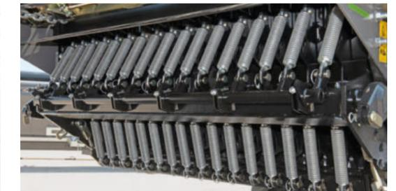
L'unité de coupe peut également pivoter de la position de travail au mode d'entretien sur simple commande hydraulique.
