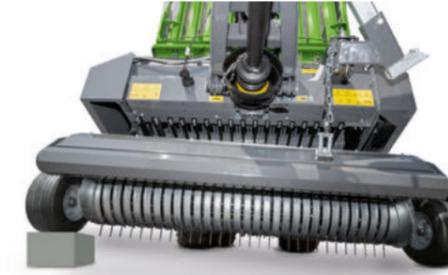
Les roues de jauge pivotantes du pick-up permettent de ramasser proprement dans les angles et protègent ainsi le tapis végétal. Réglez la hauteur des roues avec une série de perçages.
