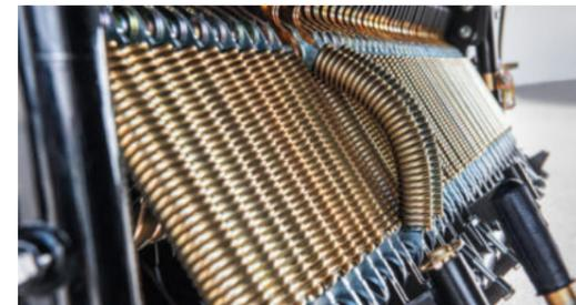
Chaque couteau est intégralement protégé grâce au système de protection contre les corps étrangers Trimatic, également disponible sur les modèles Fendt Tigo ST, S et MS.
