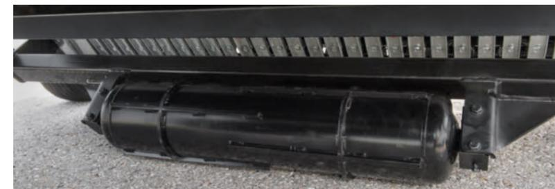
Le rouleau palpeur, qui peut être monté au centre des modèles Tigo MR et MR Profi, assure un guidage du pick-up en toute sécurité même dans les conditions les plus difficiles. Il en résulte une excellente qualité de fourrage car les saletés restent sur le sol.
