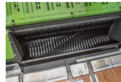
Le rotor de 800 mm de diamètre et à six rangées de dents en spirale en acier Hardox est équipé des deux côtés de roulements à rouleaux sphériques.
