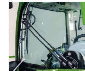
Deux essuie-glaces de pare-brise au choix : Essuie-glace rotatif à fonctionnement intermittent ou essuie-glace à balayage vertical pour un rayon d'action encore plus grand.
