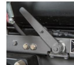
Prévention des risques et de la détérioration des outils attelés : bloquez les bras inférieurs avec la vanne d'arrêt.
