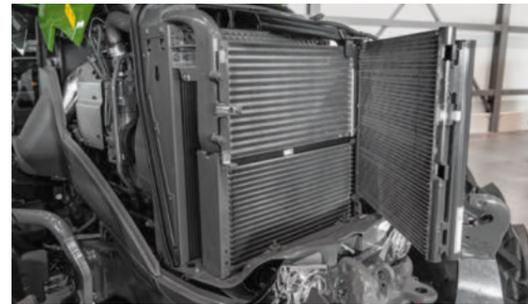
Moins d'effort : le bloc de refroidissement compact est facilement accessible tout en étant simple et rapide à nettoyer, grâce à l'écart important entre les échangeurs et le plancher plat du bloc de refroidissement.
