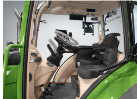
Réglage ergonomique optimum : Le volant et le tableau de bord sont très faciles et rapides à régler à l'aide de la pédale. Pour une position de conduite optimale, le volant et le tableau de bord doivent être réglés à la bonne hauteur et au bon angle d'inclinaison. Avantage : Une visibilité optimale et des reflets réduits au minimum sur le tableau de bord. Pour sortir facilement de la cabine, il suffit de faire pivoter la colonne de direction et le tableau de bord vers le haut avec la pédale.
