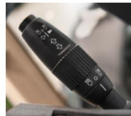
■ Particulièrement pratique et aussi confortable qu'une voiture : le retour automatique des clignotants est géré selon 3 paramètres : l'angle de braquage, le temps et la vitesse d'avancement.
