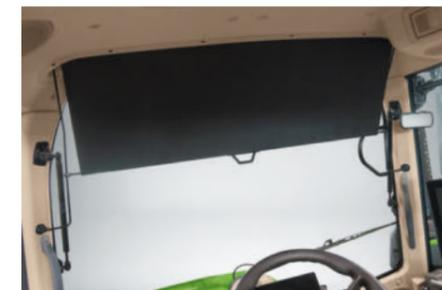
La poignée verticale de la lunette arrière est une spécificité du Fendt 300 Vario qui permet d'ouvrir et fermer simplement la fenêtre, tout en restant assis.
