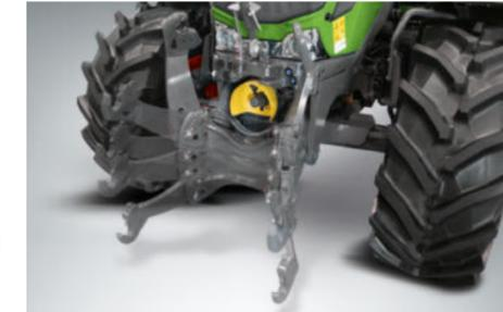
Les raccords hydrauliques à l'arrière sont parfaitement alignés et se repèrent facilement grâce à leur code couleur. Les volets anti-poussières se referment automatiquement. Le système d'accouplement sous pression permet de raccorder les distributeurs hydrauliques en charge, ce qui facilite l'attelage et le dételage des outils.
