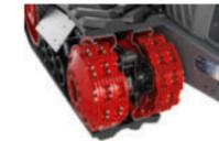
2041 kg : 36 masses pour roues de guidage (9x par roue de guidage)
