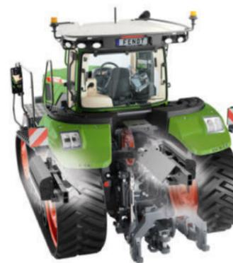
1345 kg : 32 masses à l'extérieur des trains de chenilles (16x par train) ; protection contre les débris à l'intérieur
