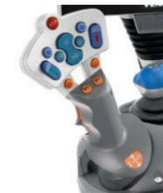
Le joystick multifonction en option comporte également des touches servant à commander deux distributeurs hydrauliques.
