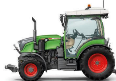
Le réservoir de GNR de 68 litres ou 83 litres (en option) à gauche de la cabine promet un long rayon d'action et un ravitaillement facile. Sans oublier le réservoir d'AdBlue de 16 litres sur la partie avant du capot. Cycles de travail plus longs, sans soucis de ravitaillement.
