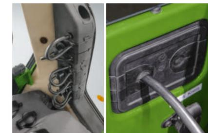
Fendt propose une solution intelligente pour les câbles en provenance de l'arrière ou de l'avant du tracteur qui pénètrent dans la cabine. Des câbles de toute taille peuvent être acheminés via des passes-câbles ingénieux. Le conducteur peut maintenir la vitre arrière fermée pour empêcher la poussière, les impuretés, l'eau et le bruit de pénétrer à l'intérieur.
