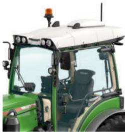
Bien protégé, le récepteur Fendt Guide est intégré dans le toit du tracteur.
