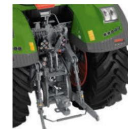
Relevage arrière avec rotules et cales de débattement
