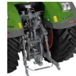
Relevage arrière avec crochets et cales (Australie)
