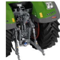
Relevage arrière avec crochets et stabilisateurs
