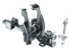
Barre oscillante cat 4 axe 38 ou 50 mm (réversible) pour échelle avec cales de débattement
